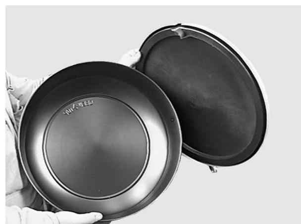
Auf richtigen Zusammenbau von Deckel und Behälter achten. Eine Aussparung im Deckelrand und ein Böckchen am Behälter müssen ineinandergreifen. Bei waagrechttem Einbau des Filters auf die Markierung "oben" am Filtertopf achten.
