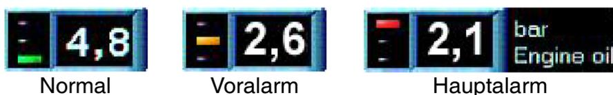
Abbildung: Beispiel einer Anzeige mit Alarmdarstellung
