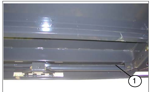
1. Стопорная труба поворотной опоры является стандартной деталью на машинах без системы управления положением жатки
