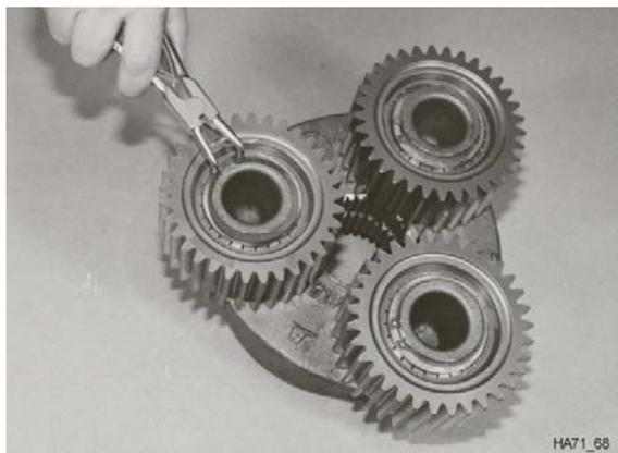
Encaixe os anéis retentores.
