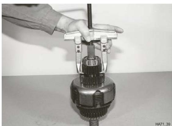
Retire a caixa de cobertura da embraiagem e a engrenagem de dentes direitos do veio da embraiagem juntamente com o rolamento.
