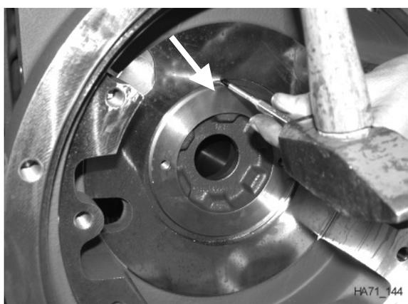
Monte a cavilha ranhurada em ambos os lados para fixar os parafusos de ajuste.
