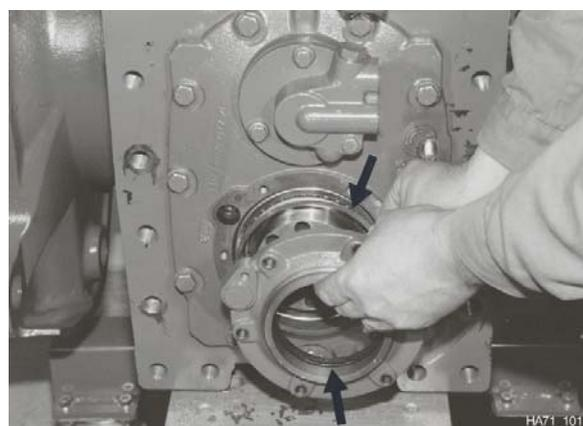
Instale o calço de ajuste calculado com o procedimento acima.
