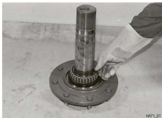
Aqueça o rolamento de rolos cónicos (sem anel externo) a 80°C e instale-o.
