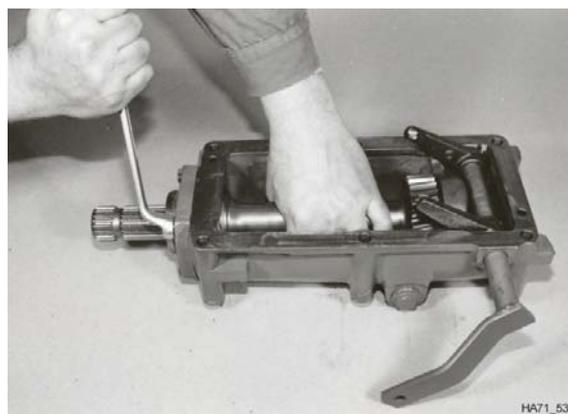
Retire a caixa de saída completamente do cárter da ponte traseira.
