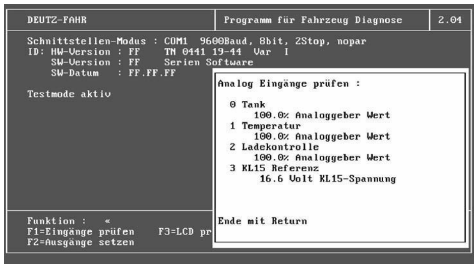
Fig. 59 - Ventana Check analog inputs
