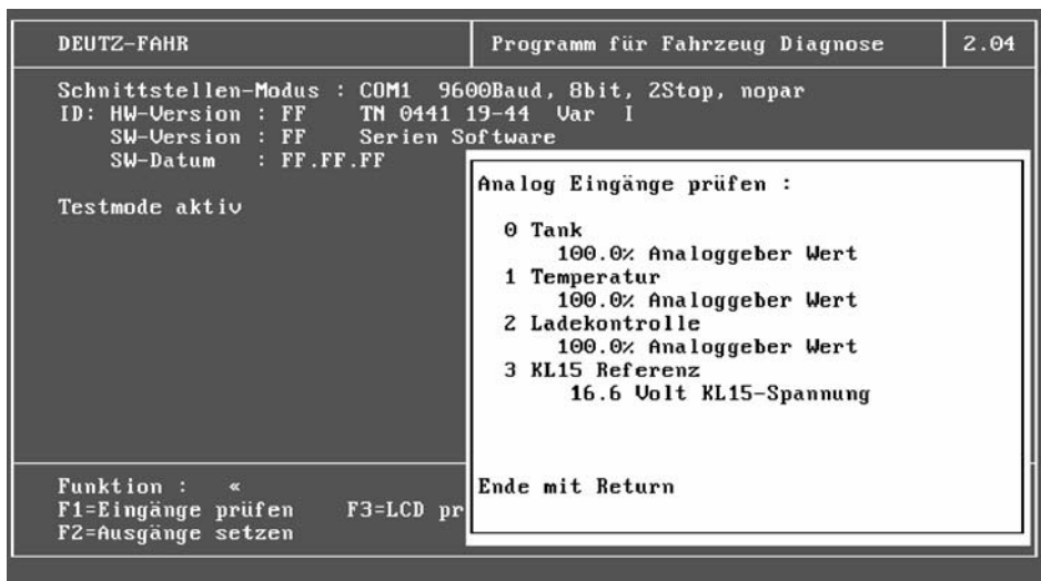
Fig. 59 - Ventana Check analog inputs
