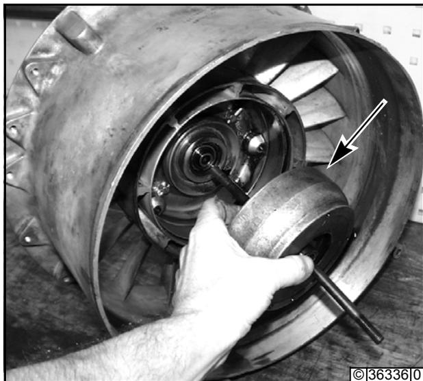
**Ensamblar el ventilador de refrigeración**
