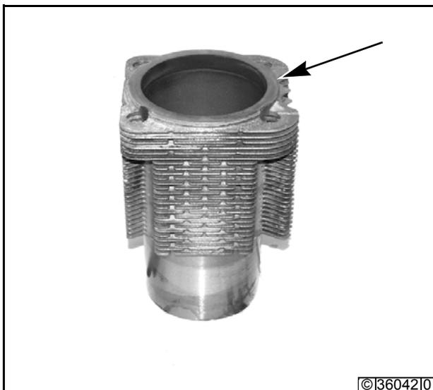
● Verificar si existe deterioro en la superficie de asiento superior del cilindro.
