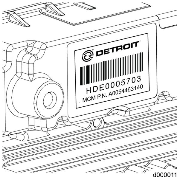
**Figure 16. Motor Control Module Label**
