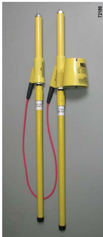
FIGURE 20-2. VOLT METER (PC3186)
