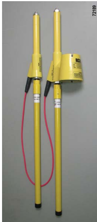
FIGURE 20-2. VOLT METER (PC3186)
