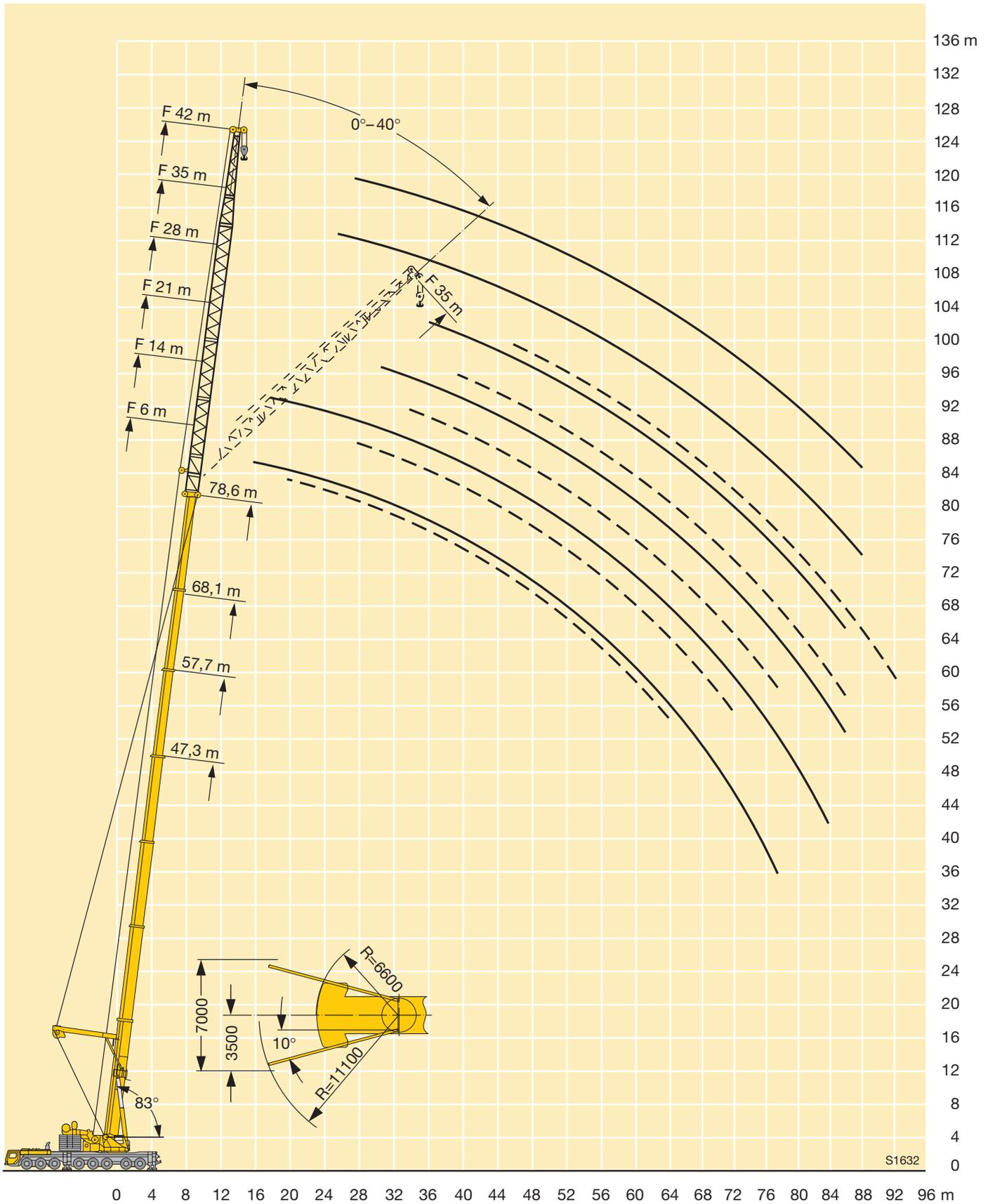
**Traglasten am abgespannten Teleskopausleger mit hydraulisch verstellbarer Gitterspitze und Exzenter**
