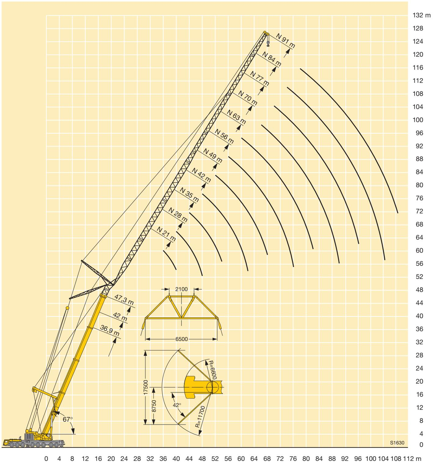
**Traglasten an der hydraulisch verstellbaren festen Gitterspitze**
