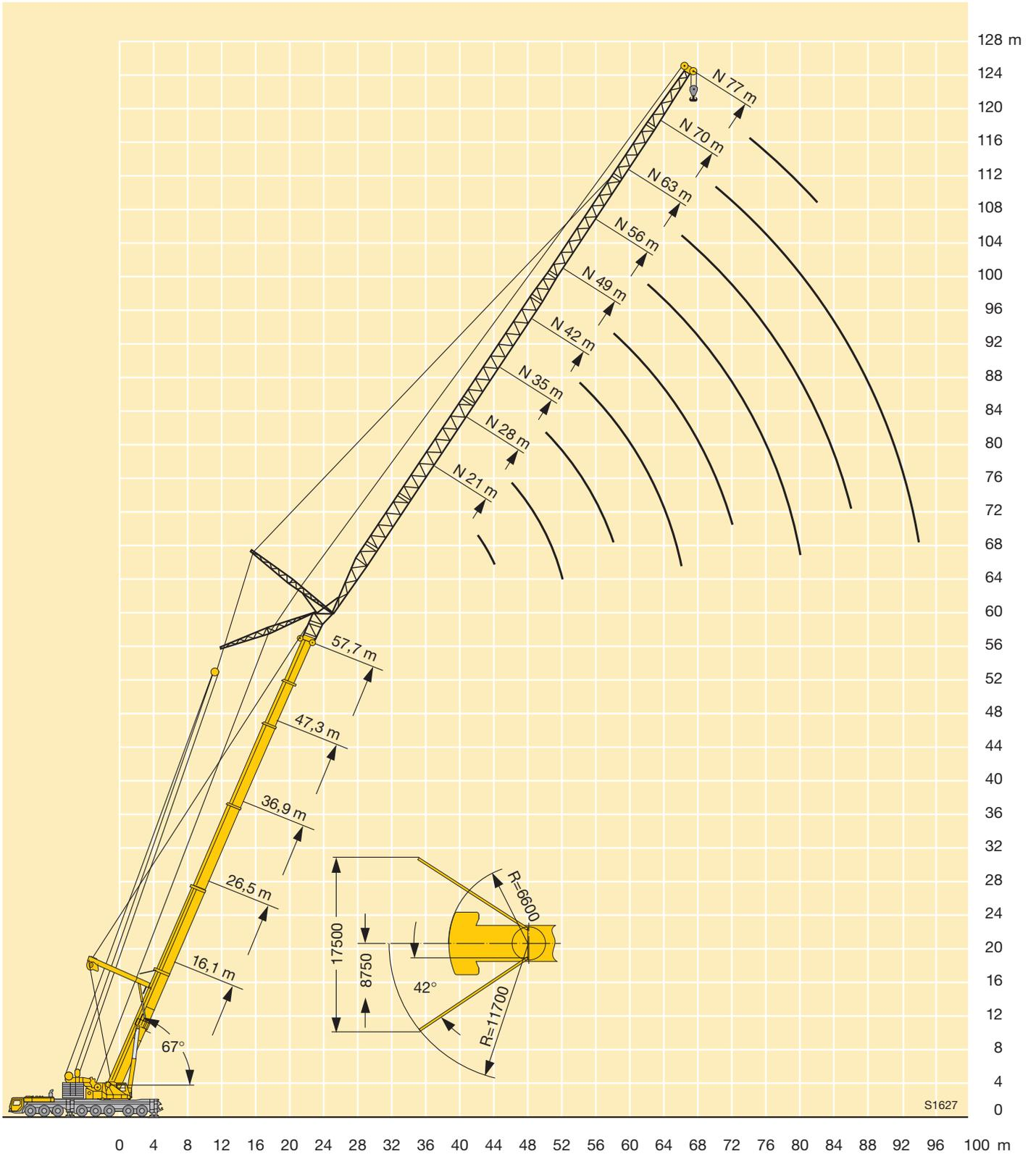
**Traglasten an der wippbaren Gitterspitze mit abgespanntem Teleskopausleger und Spacer**
