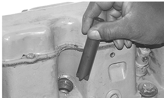
Очистка посадочных поверхностей форсунок в головке блока цилиндров
