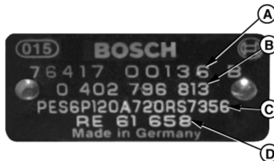
Идентификационная табличка нагнетательного топливного насоса «Бош»
