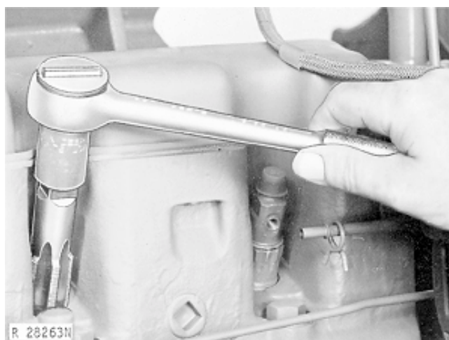
Использование метчика для очистки резьбы в отверстиях форсунки
