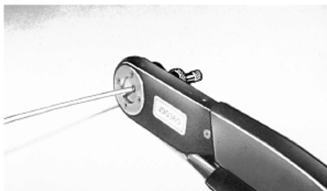
Заделка обжатием контакта DEUTSCH™
