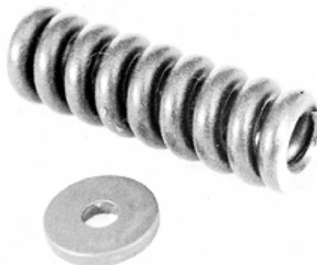
Проверка пружины форсунки и прокладок
