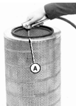
Очистка первичного элемента
