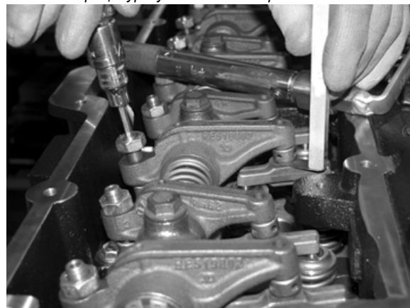
Проверка клапанного зазора при помощи изогнутого толщиномера
