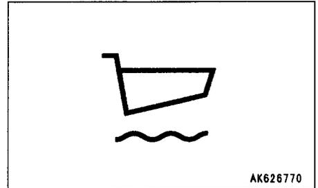
**5. ЗАСОРЕНИЕ ФИЛЬТРА КОРОБКИ ПЕРЕДАЧ**
