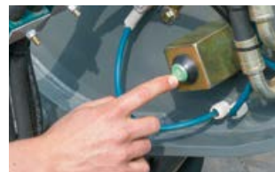
Heel eenvoudig – met een druk op de knop – wordt de drukontlasting van het derde regelcircuit ingeschakeld voor op de zwanenhals.
