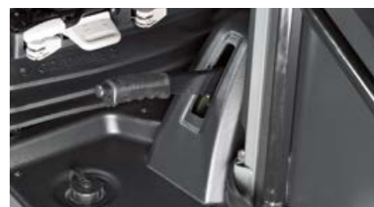
Mechanische handrem links naast de stoel bij de 3-t en 3,5-t machines
