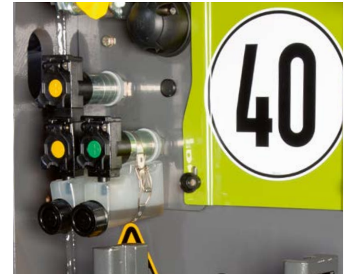
Hydrauliekaansluitingen achter met lekolie opvang en luchtdruk remsysteem
