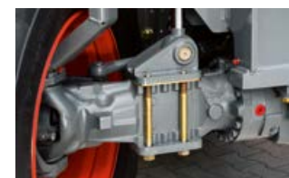
Blokkering van de pendelend opgehangen achteras
