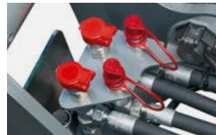
Twee dubbelwerkende aansluitingen op de werktuigendrager
