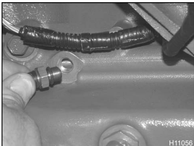
Figura 500 Retiro de la válvula de combustible (orificio de purga y prueba de presión)
