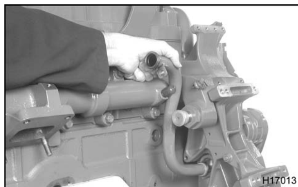
Figura 99 Tubo de suministro del enfriador de EGR
