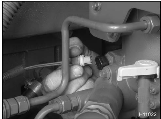
Figura 432 Desconexión del WIF
