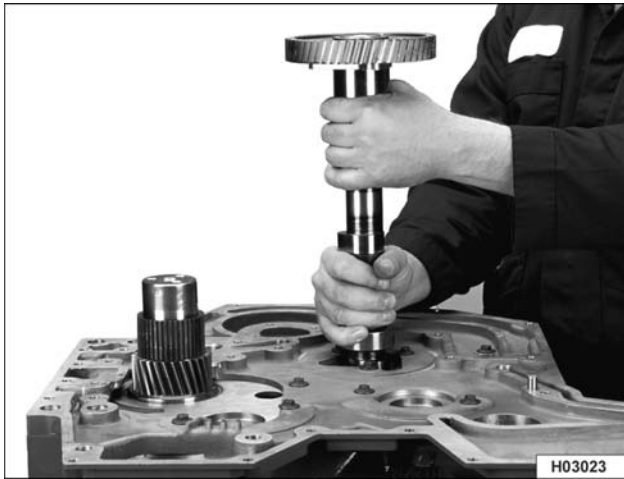
Figura 340 Retiro del conjunto del árbol de levas
