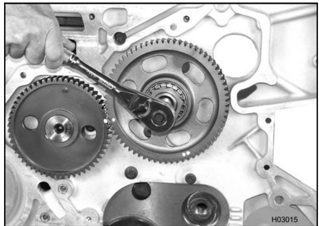
Figura 217 Retiro del engranaje libre superior
