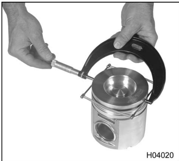
Figura 286 Medición de las ranuras del pistón con espigas calibradas
