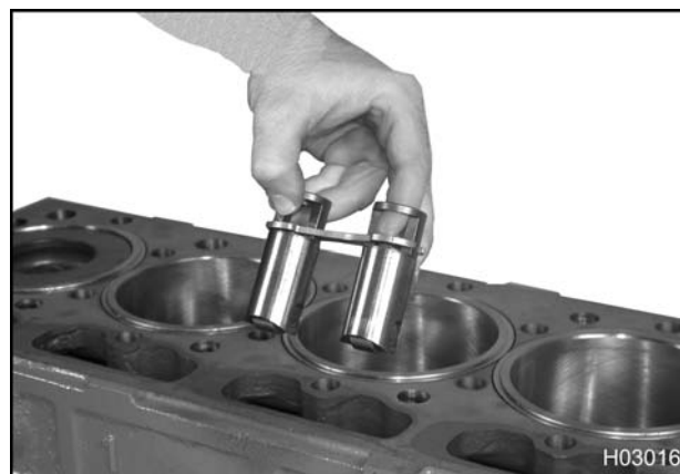
Figura 371 Instalación de los levantaválvulas
