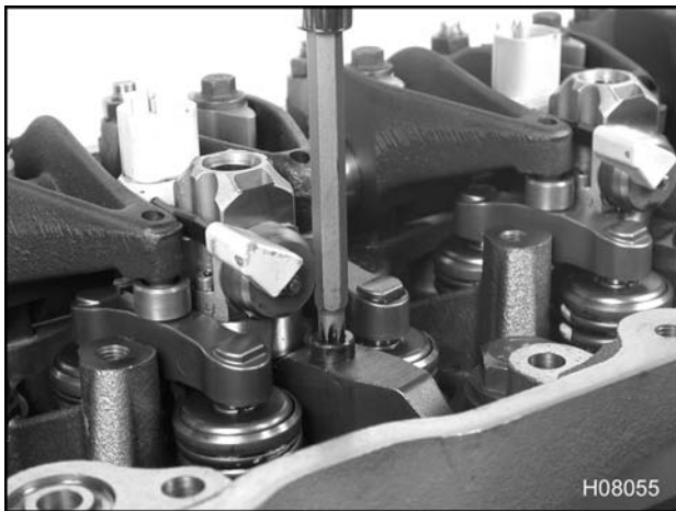
Figura 518 Instalación del sujetador
