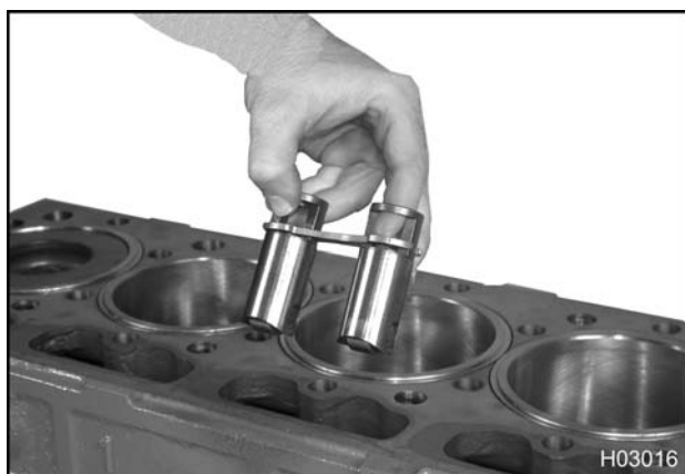
Figura 337 Retiro de los levantaválvulas
