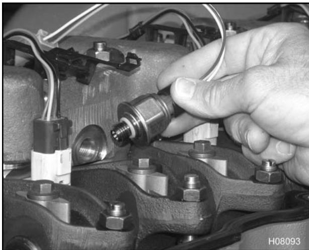
Figura 589 ICP con sello anular
