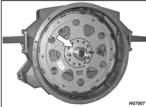
Figura 579 Instalación del anillo de refuerzo con la marca de pintura
