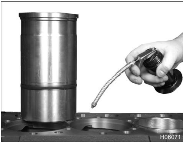
Figura 311 Lubrique la cavidad donde va la camisa
