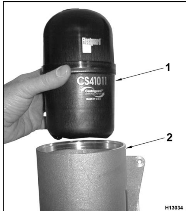
Figura 391 Filtro secundario retirado (opcional)
