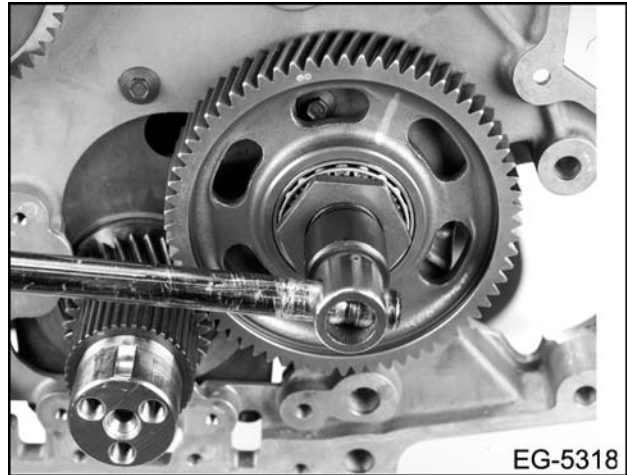
Figura 216 Retiro del engranaje libre inferior
