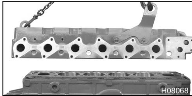
Figura 175 Descenso de la culata sobre el bloque
