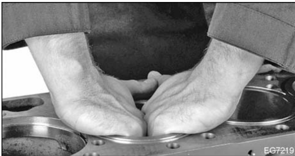
Figura 312 Instalación de la camisa
