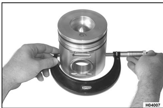
Figura 288 Medición del diámetro de la falda del pistón
