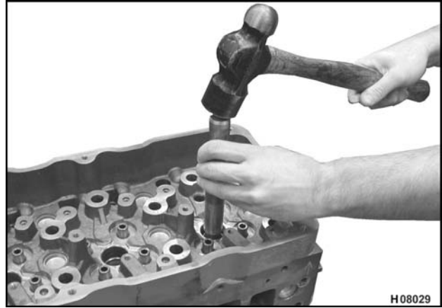
Figura 170 Instalación de la camisa
