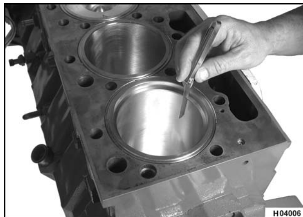
Figura 289 Medición de la abertura de los anillos
