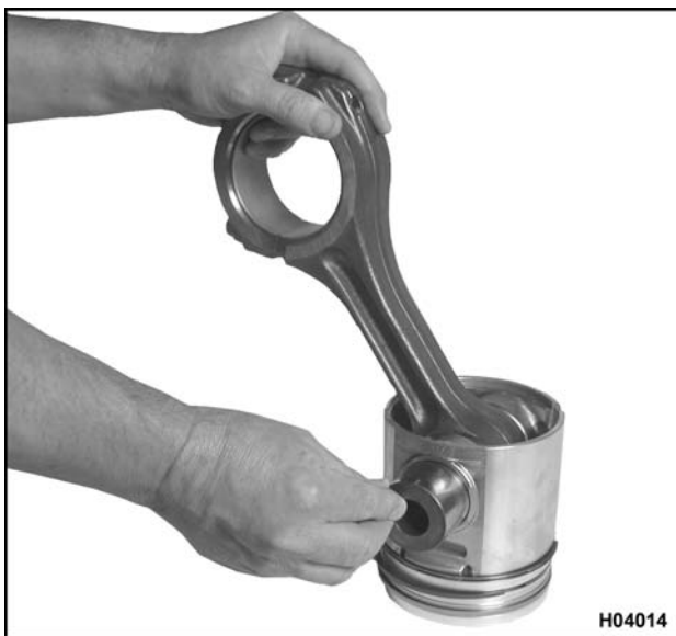
Figura 315 Instalación del pasador del pistón
