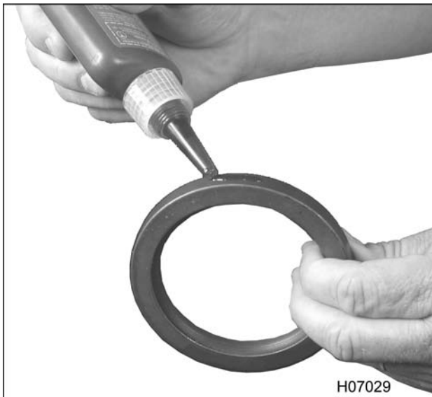
Figura 235 Aplicación de sellador hidráulico Loctite® al sello de aceite delantero
