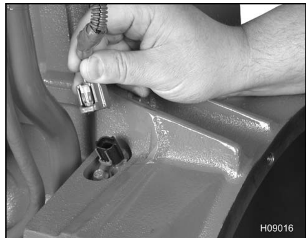
Figura 474 Conexión al CKP
