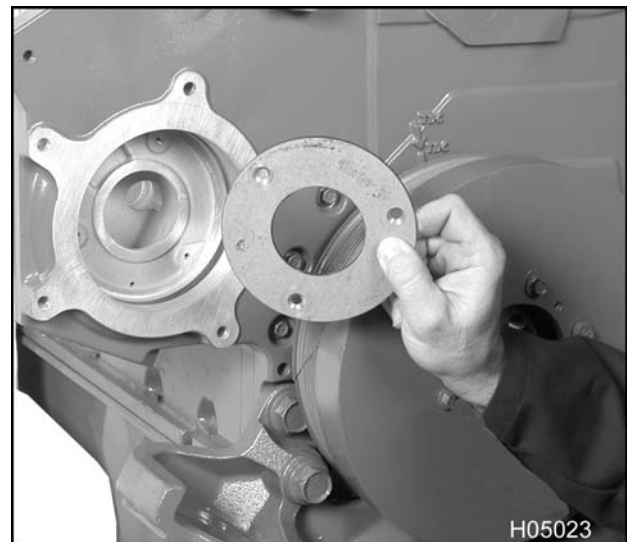
Figura 249 Instalación de la placa de desgaste
