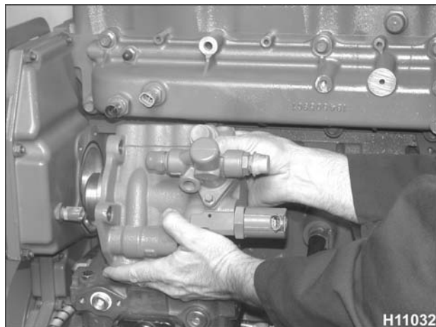
Figura 502 Retiro de la bomba de alta presión
