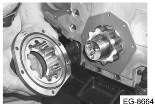
Figura 237 Carcasa de la bomba de aceite
