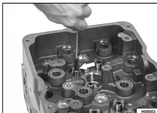
Figura 141 Limpieza de las guías de válvula
