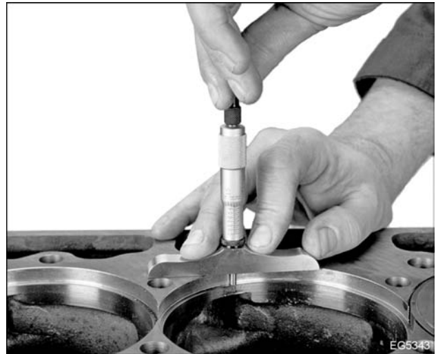
Figura 302 Medición de la profundidad del abocardado con un micrómetro de profundidad
