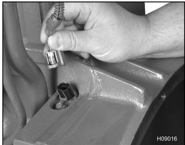
Figura 433 Desconexión del CKP
