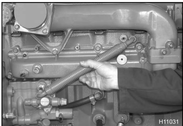
Figura 501 Retiro de la manguera de aceite de alta presión
