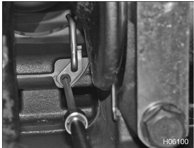
Figura 326 Tubo enfriador de pistón
