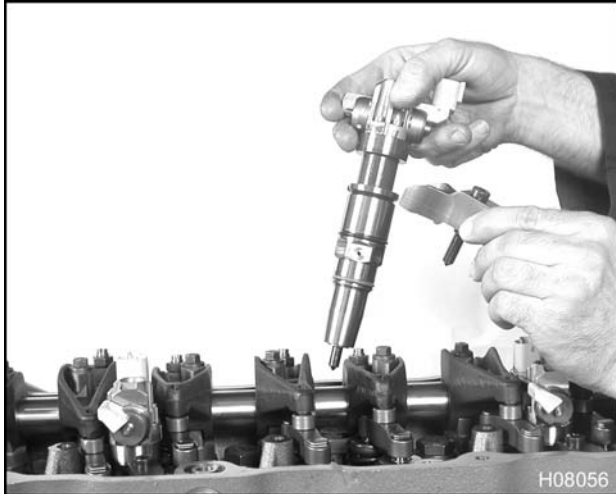
Figura 517 Instalación del inyector
