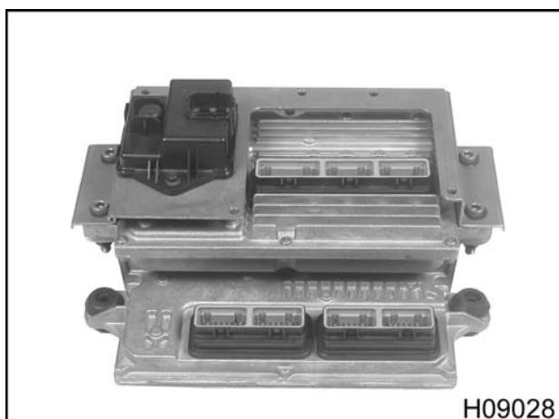
Figura 446 Unidad con el módulo impulsor del EGR, el IDM y el ECM
