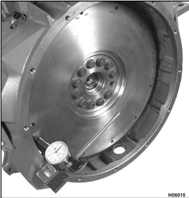
Figura 576 Medición de la desviación de la superficie del volante
