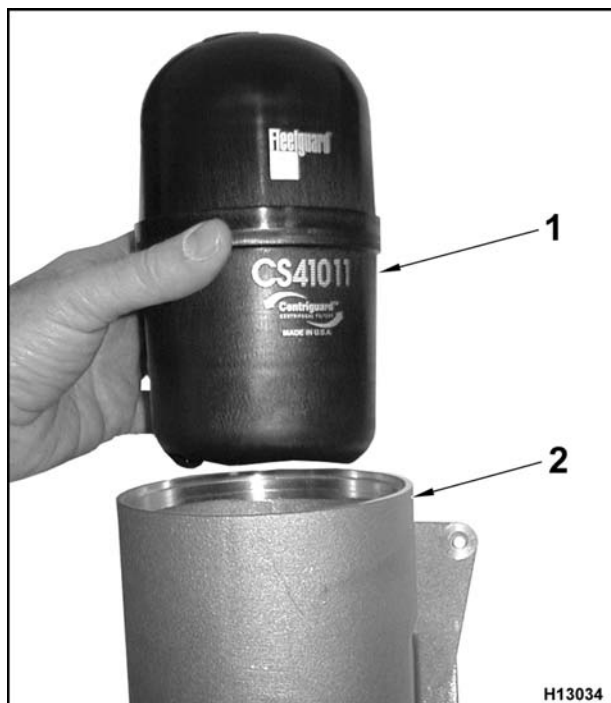
Figura 401 Instalación del filtro secundario (opcional)
