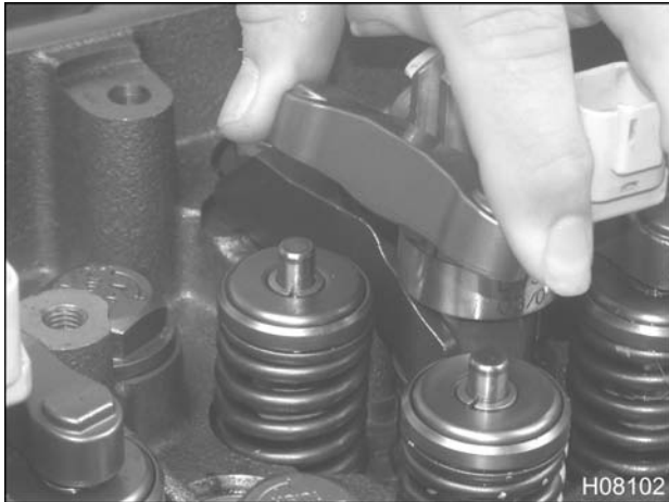
Figura 118 Retiro de los puentes de válvula
