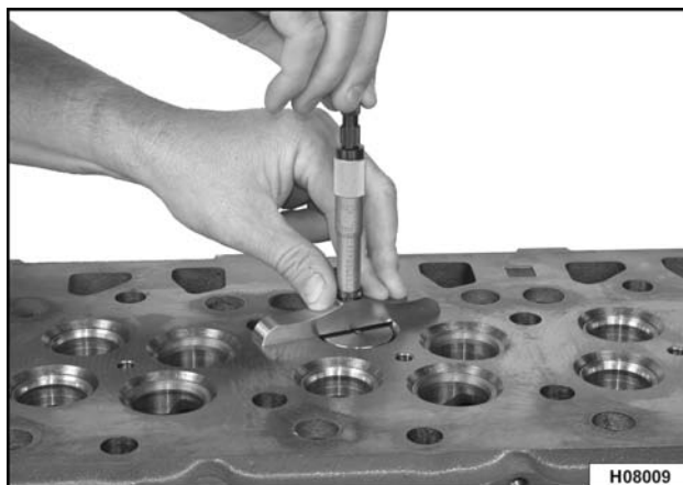
Figura 156 Medición de la recesión de la válvula
