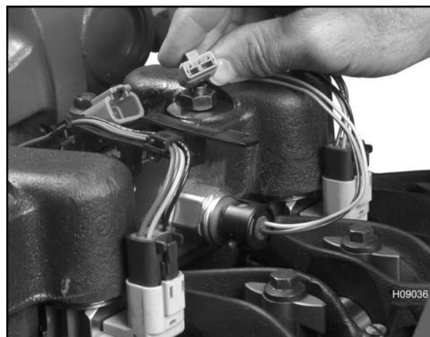
Figura 456 Conexión del BCP
