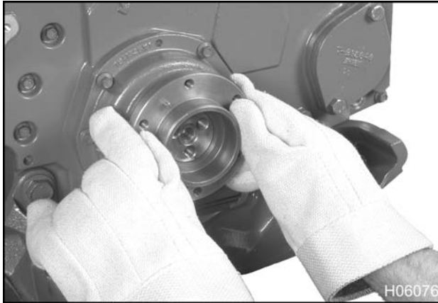
Figura 240 Instalación del amortiguador de vibraciones
