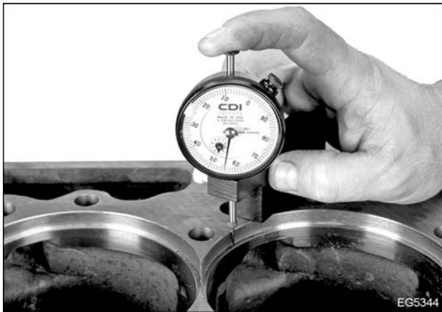
Figura 301 Medición de la profundidad del abocardado con un calibrador de superficie
