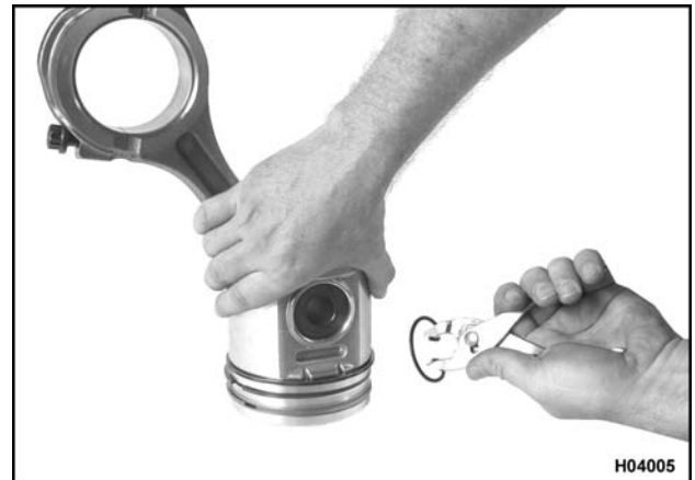
Figura 316 Instalación de los anillos de retención
