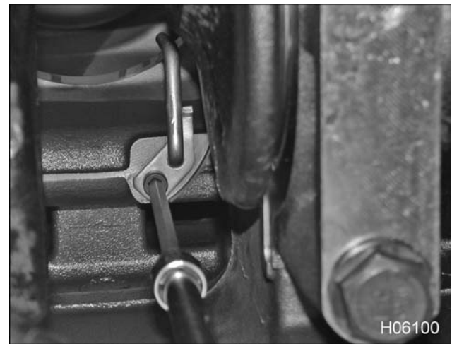
Figura 275 Tubo enfriador de pistón
