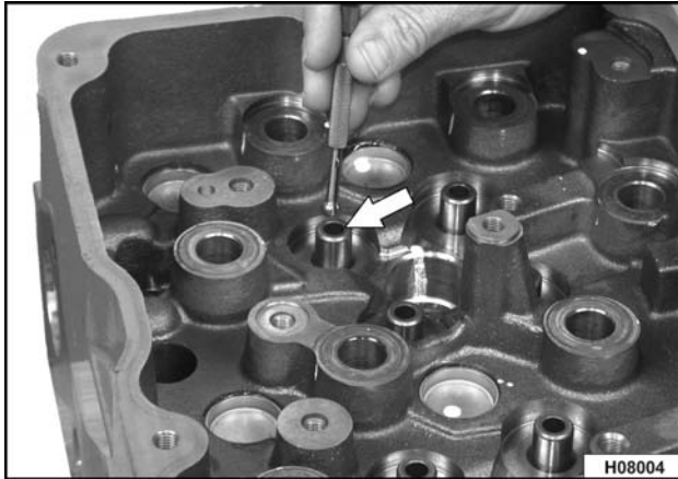
Figura 142 Medición de las guías de válvula con un calibrador de bola
