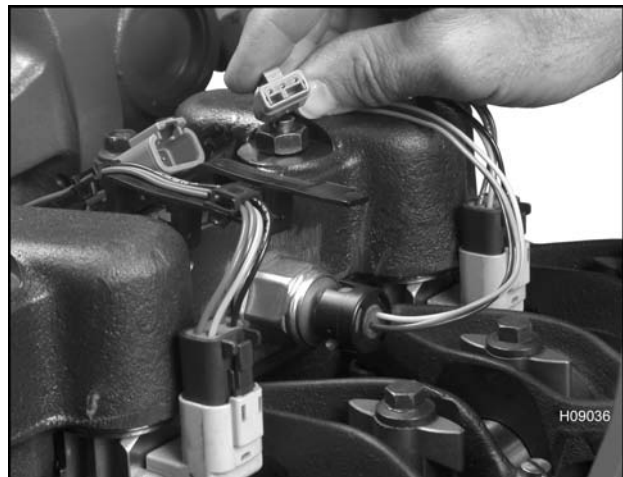
Figura 451 Desconexión del BCP
