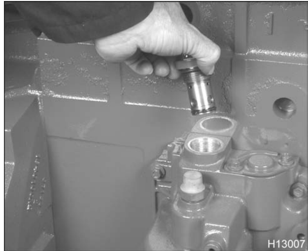
Figura 399 Instalación de la válvula reguladora de la presión de aceite
