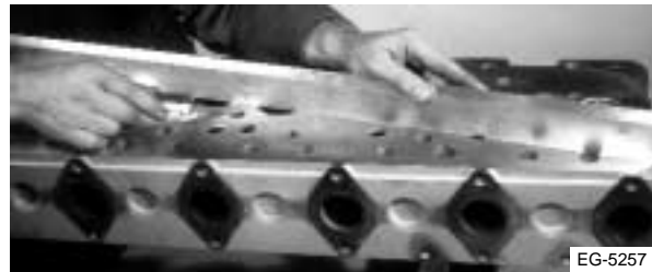
Figura 4.24 Inspección por combadura
