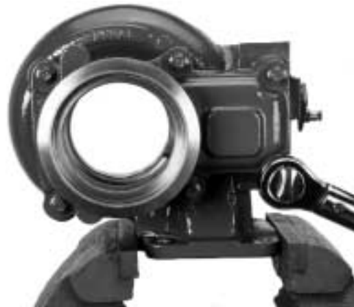
Figura 2.21 Instalación de la tapa de la compuerta de descarga
