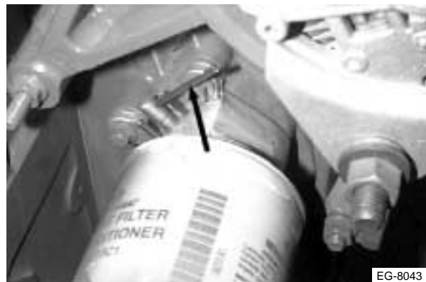
Figura 10.12 Retiro del filtro del refrigerante
