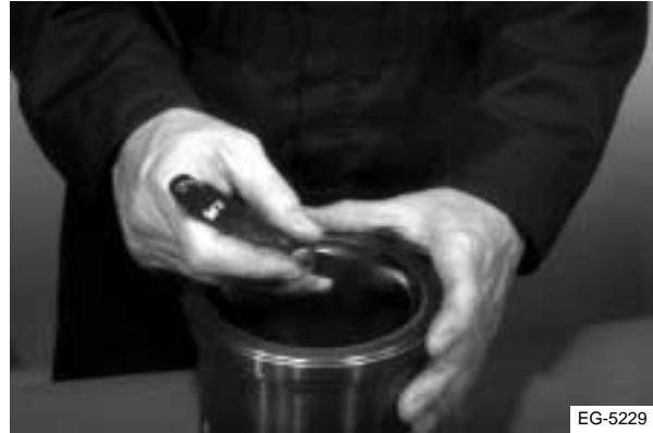
Figura 6.24 Mida la holgura del anillo superior de compresión, arriba del extremo superior del recorrido del anillo.
