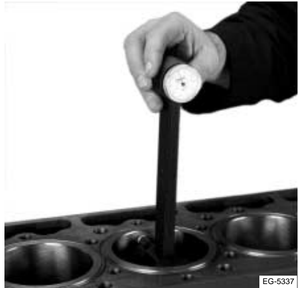
Figura 6.22 Tome la medida en la parte superior del recorrido del anillo del pistón con el medidor de diámetros interiores
