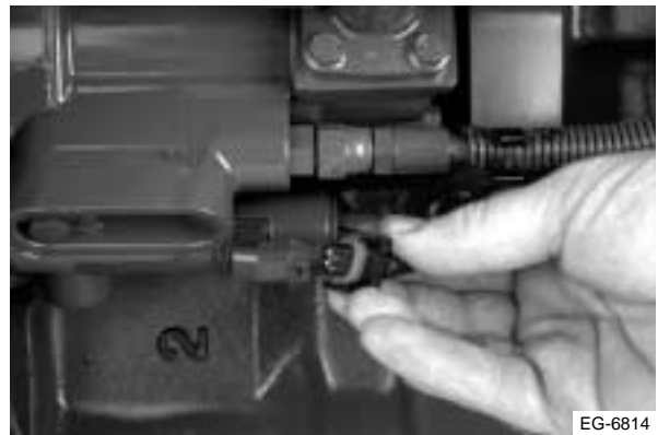
Figura 11.28 Retire el conector del IPR
