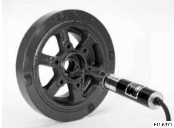
Figura 7.94 Uso del calentador de amortiguador de vibraciones
