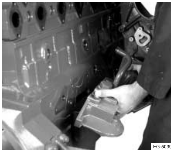
Figura 1.8 Retiro del enfriador de aceite
