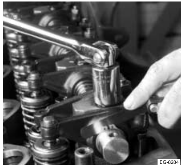
Figura 4.76 Ajuste de los pernos de montaje
