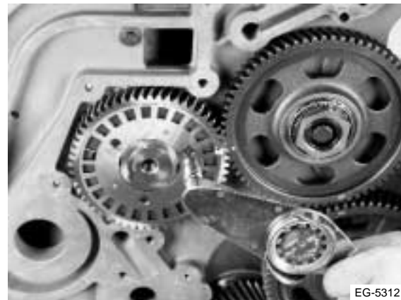
Figura 5.35 Instalación del disco de sincronización
