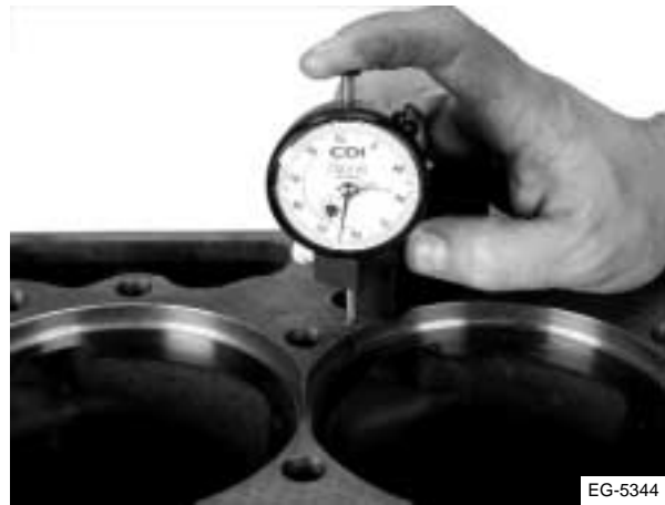
Figura 6.30 Medición de la profundidad de los abocardados con un calibrador de superficies
