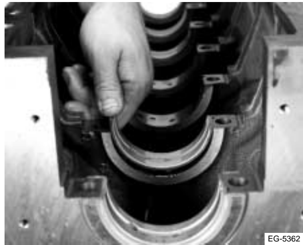
Figura 7.78 Instalación de los casquillos superiores
