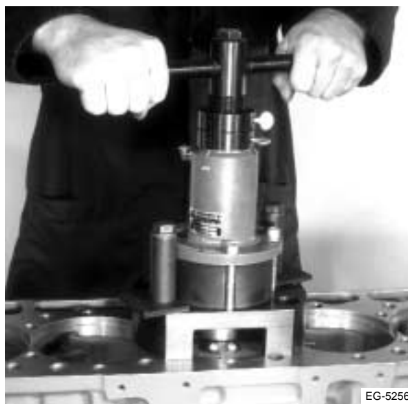
Figura 6.36 Forma de usar el cortador de abocardados
