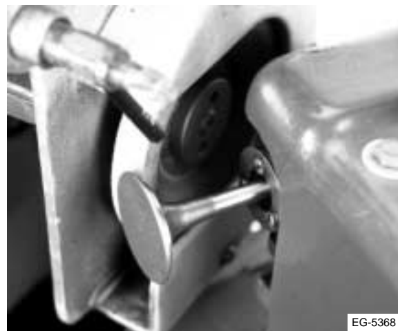
Figura 4.41 Rectificación de la cara de la válvula
