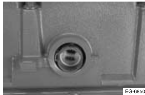
Figura 3.9 Conector del haz de cables
