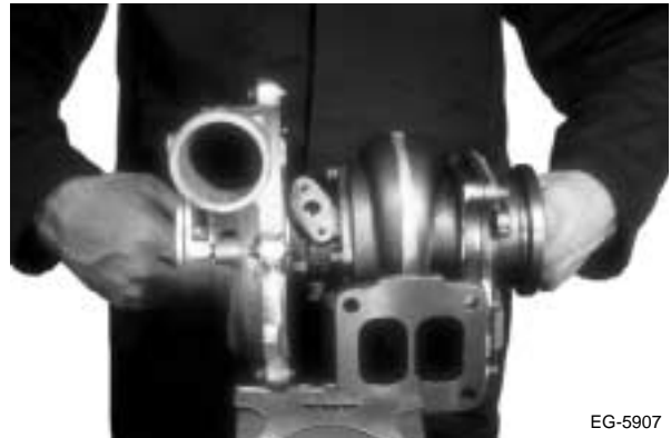
Figura 2.8 Revisión por rozamiento en las cajas protectoras de la turbina y compresor
