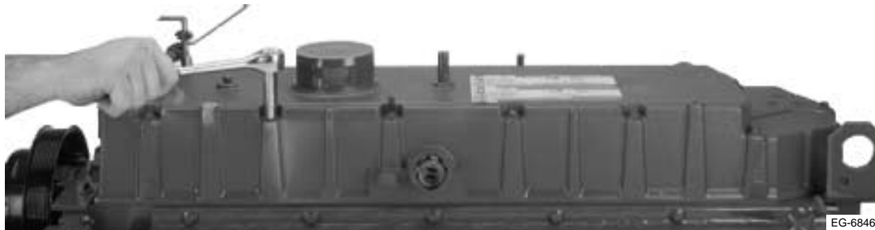
Figura 3.10 Retiro de la tapa de válvulas / múltiple de admisión
