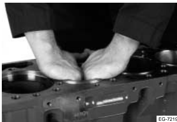
Figura 6.46 Instalación de las camisas
