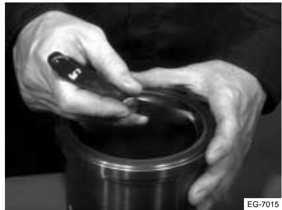
Figura 6.25 Mida la holgura del anillo superior de compresión, debajo del extremo inferior del recorrido del anillo.
