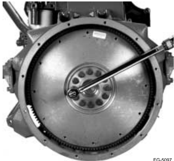
Figura 7.30 Instalación del volante
