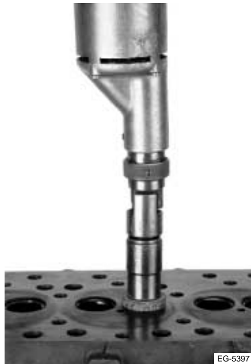
Figura 4.46 Uso del instalador de asientos de válvula ZTSE-4164-A
