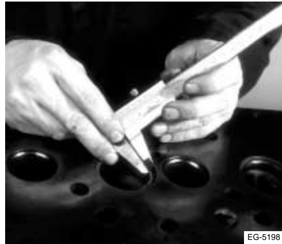
Figura 4.47 Verificación del asiento de la válvula después de esmerilar
