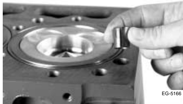
Figura 4.71 Instalación de los anillos de media caña
