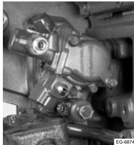
Figura 12.18 Retiro de la bomba de alta presión
