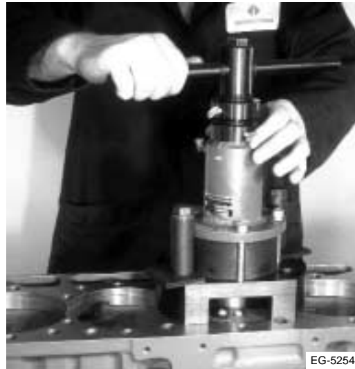
Figura 6.34 Coloque el cortador de abocardados
