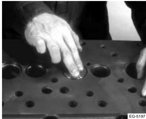
Figura 4.45 Haga girar la válvula en la culata
