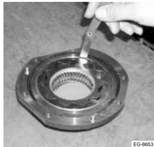
Figura 9.8 Inspección del desgaste de los rotores
