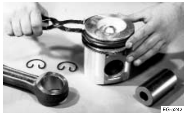
Figura 6.10 Retiro de los anillos
