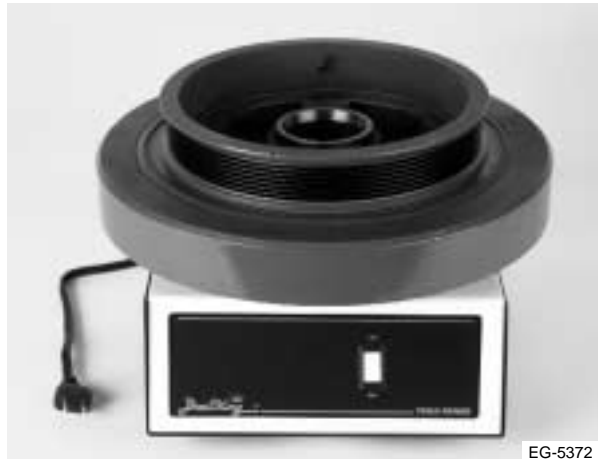
Figura 7.95 Calentamiento del amortiguador de vibraciones en una cocina portátil
