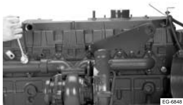
Figura 3.5 Retire el múltiple de escape
