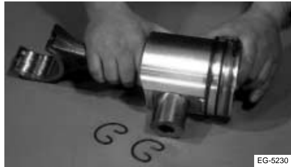
Figura 6.8 Retiro de los pasadores
