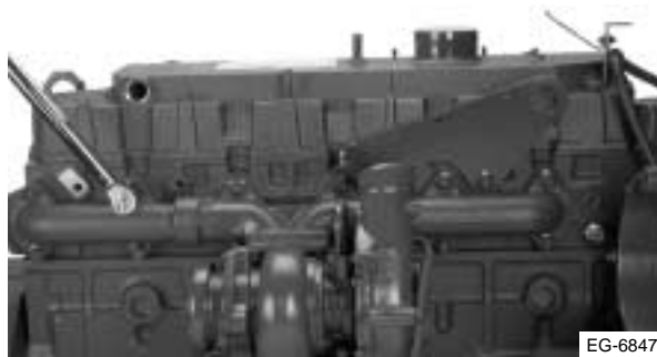
Figura 3.7 Instalación del múltiple de escape
