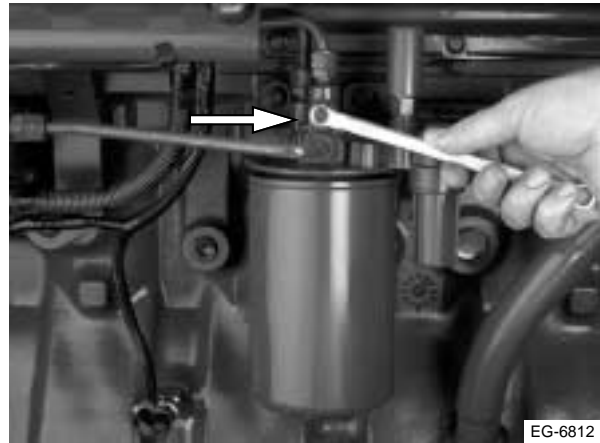
Figura 13.17 Afloje el tornillo de purga del filtro de combustible
