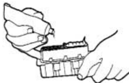
Figura 11.13 Aplicación de grasa dieléctrica
