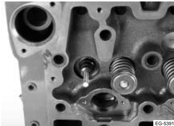
Figura 4.67 Instalación del conjunto del sello del vástago de la válvula
