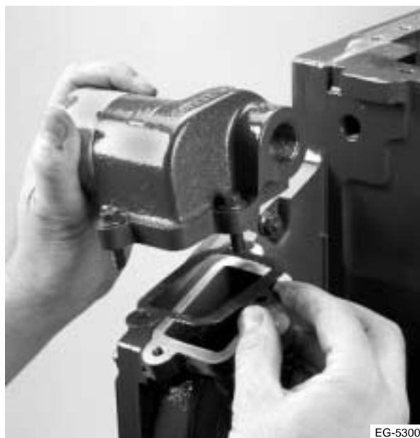
Figura 10.17 Instalación del codo de entrada de agua
