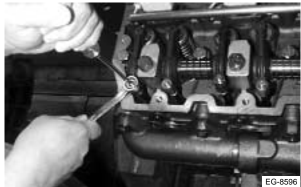
Figura 4.78 Ajuste de las tuercas de seguridad
