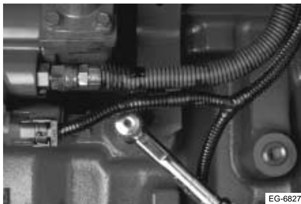
Figura 11.12 Perno inferior del soporte de montaje
