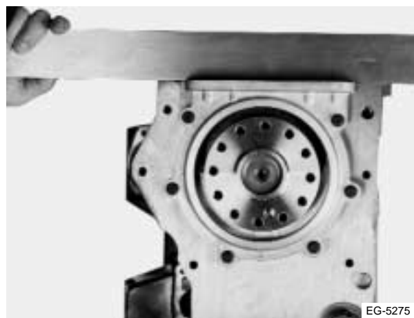
Figura 7.22 Alineación del soporte del sello
