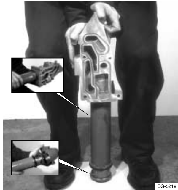
Figura 9.22 Conjunto del enfriador de aceite
