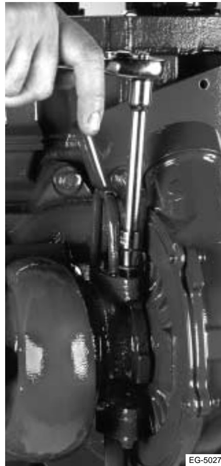
Figura 2.5 Retiro de los pernos del tubo de suministro de aceite
