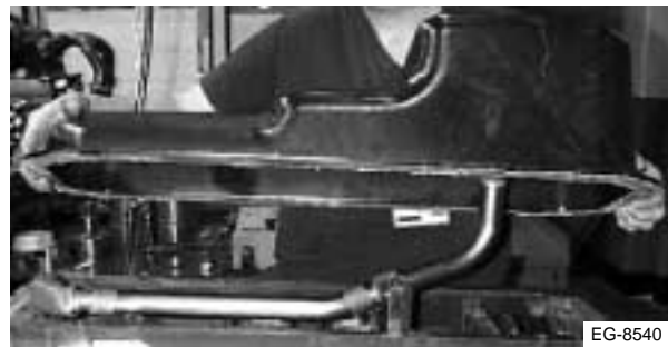
Figura 7.56 Retiro del cárter
