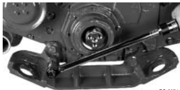
Figura 7.91 Instalación del soporte de montaje delantero
