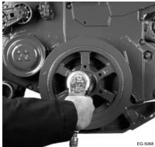
Figura 7.59 Retiro del retenedor del amortiguador de vibraciones
