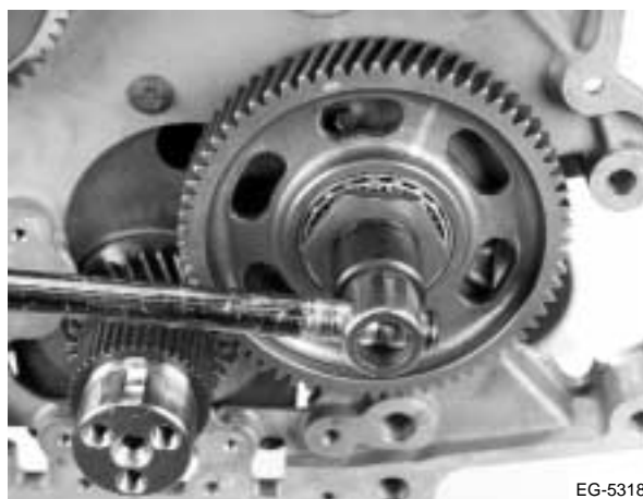
Figura 8.19 Retiro del engranaje libre inferior
