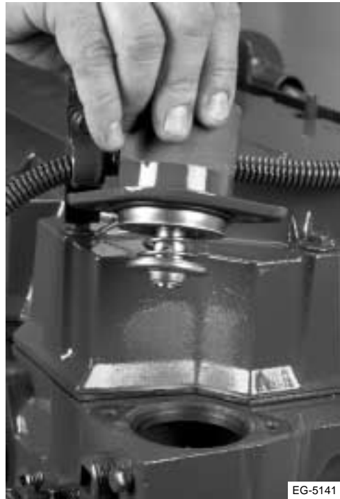
Figura 10.11 Instalación del termostato
