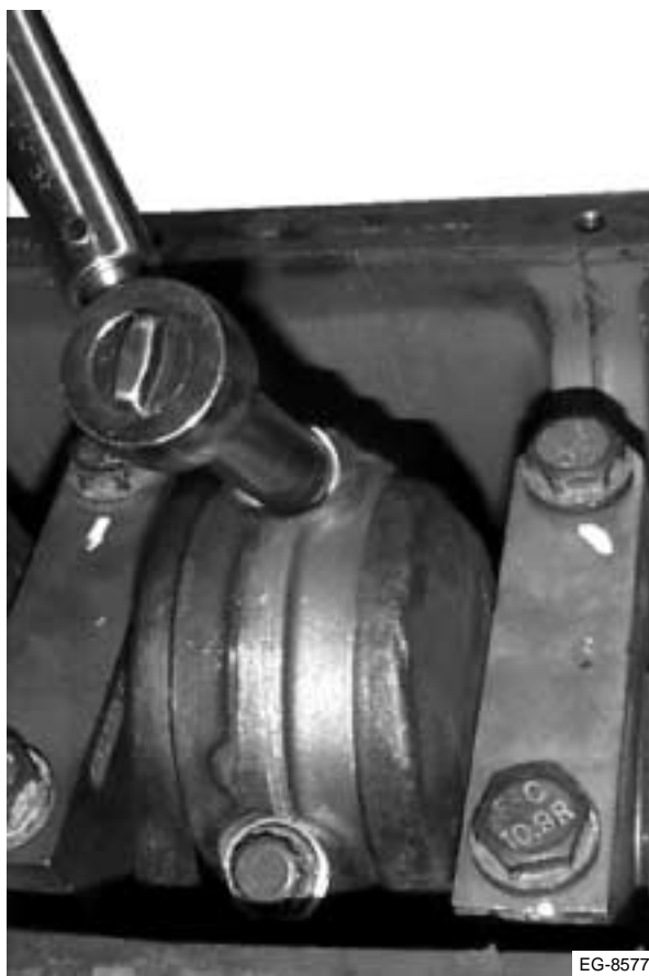
Figura 6.50 Ajuste de la tapa del cojinete de biela
