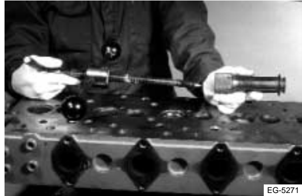
Figura 4.50 Instalación de la boquilla en el mango
