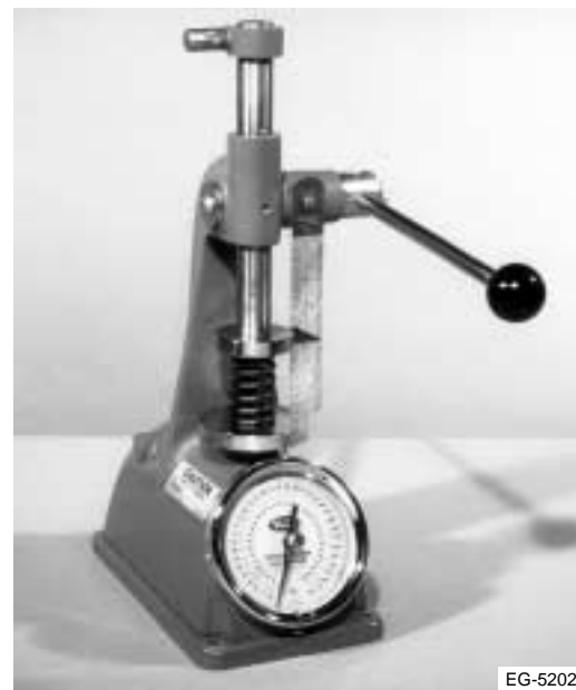
Figura 4.56 Revisión de la tensión de los resortes
