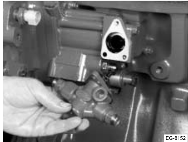
Figura 13.9 Inspección del émbolo de la bomba
