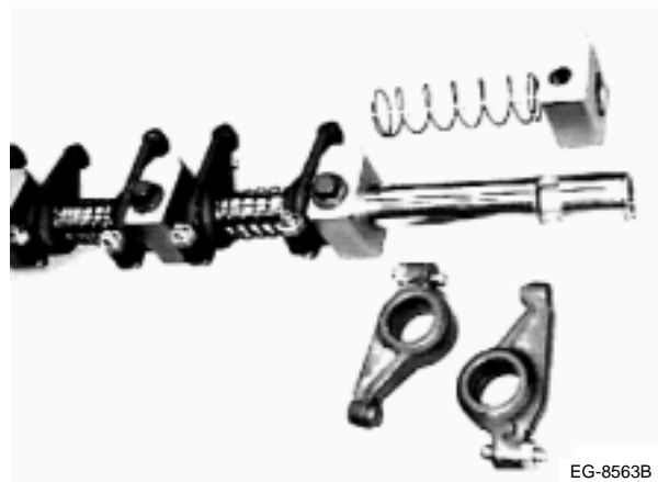
Figura 5.15 Ensamblaje del conjunto de balancines
