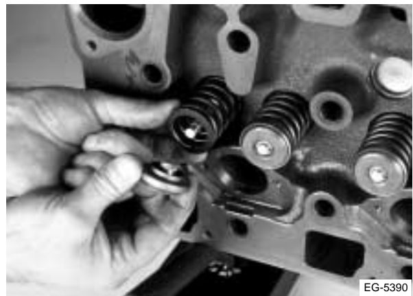
Figura 4.69 Instalación del conjunto rotador
