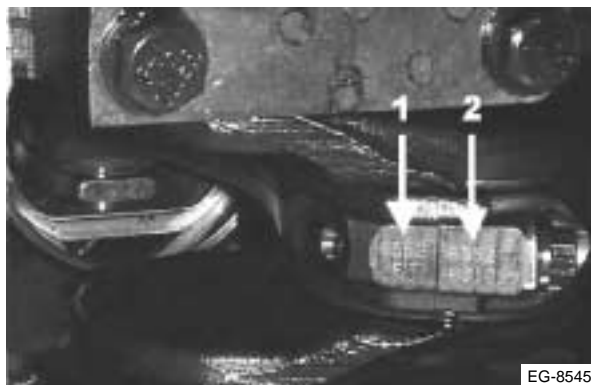
Figura 6.49 Haciendo coincidir la biela y la tapa de cojinete
