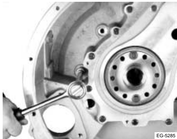
Figura 7.36 Retiro de los pernos de montaje de la toma de fuerza trasera
