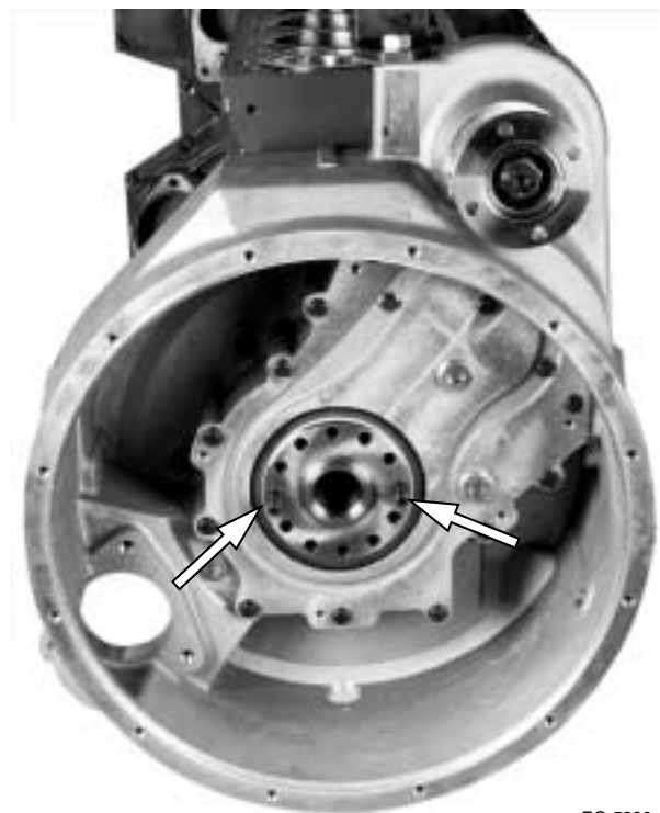
Figura 7.53 Instalación del volante
