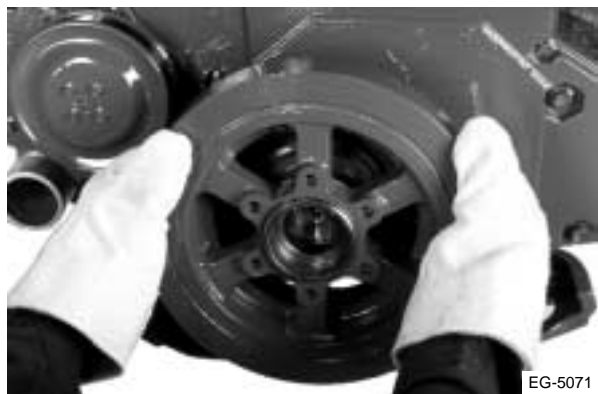
Figura 7.96 Instalación del amortiguador de vibraciones
