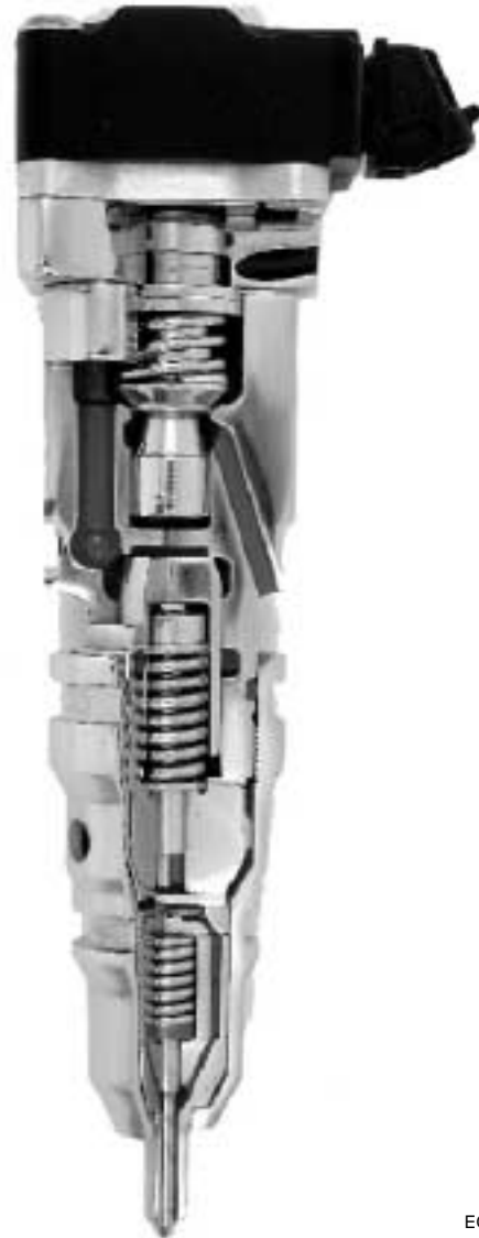
Figura i.18 Operación del inyector
