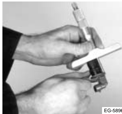
Figura 11.41 Medición del CMP con el micrómetro de profundidad (OEM 1013)
