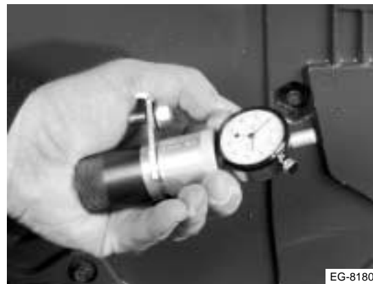
Figura 11.39 Herramienta de medir en taza de calibración
