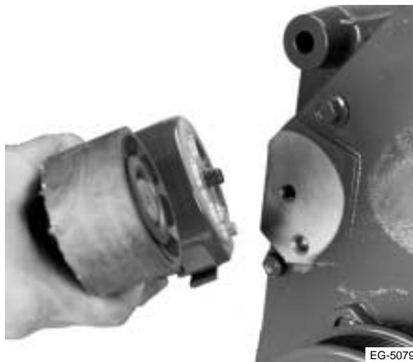
Figura 8.38 Instalación del tensor automático de la correa
