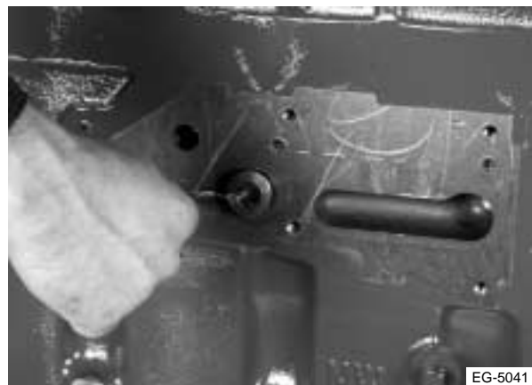
Figura 9.21 Ubicación de la válvula reguladora de la presión de aceite
