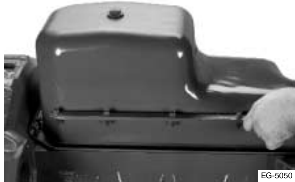
Figura 7.89 Instalación de las barras de montaje del cárter
