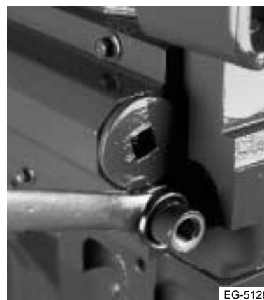
Figura 12.9 Retiro de la válvula de retorno de combustible
