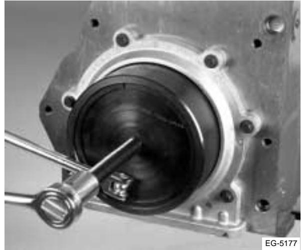
Figura 7.13 Retiro de la camisa de desgaste
