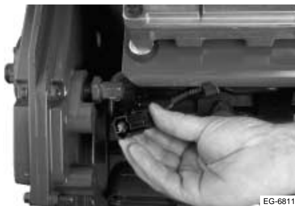
Figura 11.30 Retire el conector del EOT
