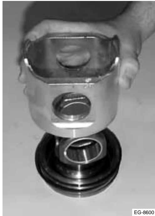
Figura 6.40 Ensamblaje de pistones de dos piezas (las piezas están boca abajo para armarlas)
