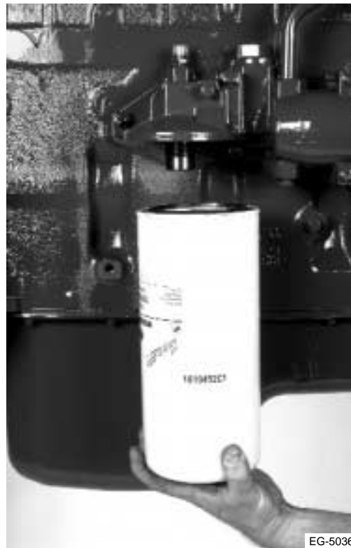
Figura 9.25 Instalación del filtro de aceite
