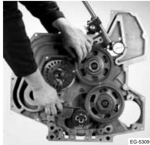
Figura 8.16 Revisión del juego entre dientes del engranaje libre superior
