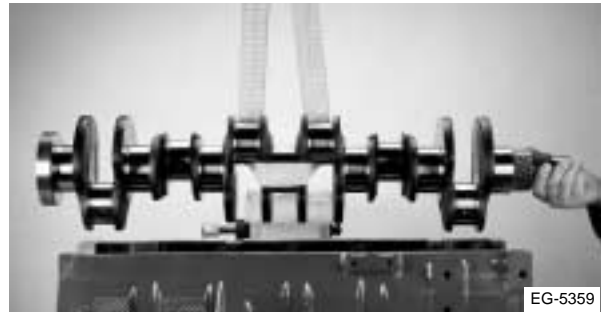
Figura 7.80 Instalación del cigüeñal
