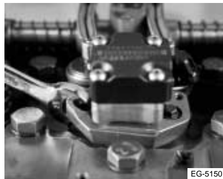
Figura 4.90 Fije la abrazadera de sujeción
