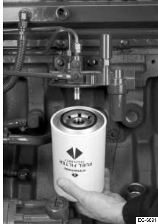
Figura 13.16 Instalación del filtro de combustible
