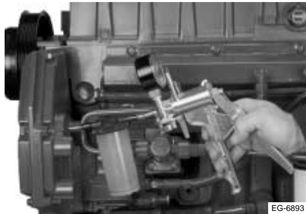
Figura 12.17 Retiro del aceite del depósito
