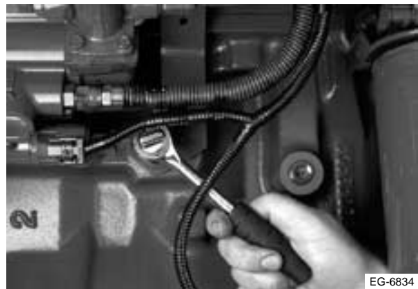
Figura 11.8 Pernos inferiores del soporte de montaje del ECM
