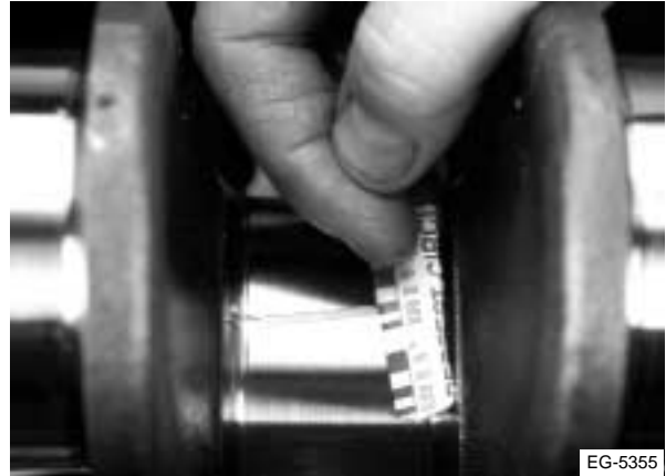
Figura 7.81 Plastigage para medir
