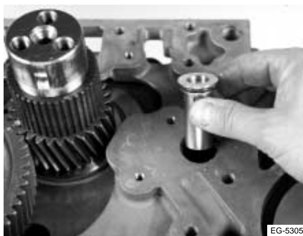
Figura 8.27 Instalación de la válvula de descarga de la presión del aceite
