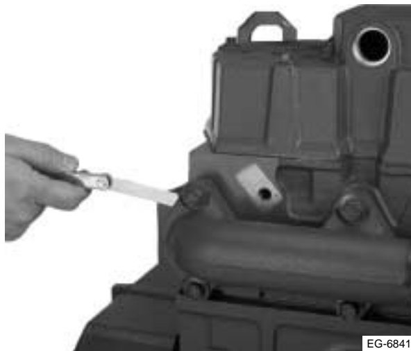
Figura 3.6 Inspeccione el múltiple de escape en busca de fisuras y combadura
