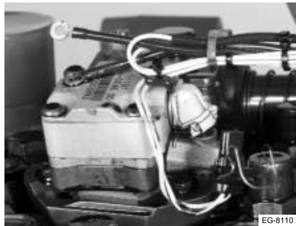
Figura 4.5 Retire el retenedor de alambre
