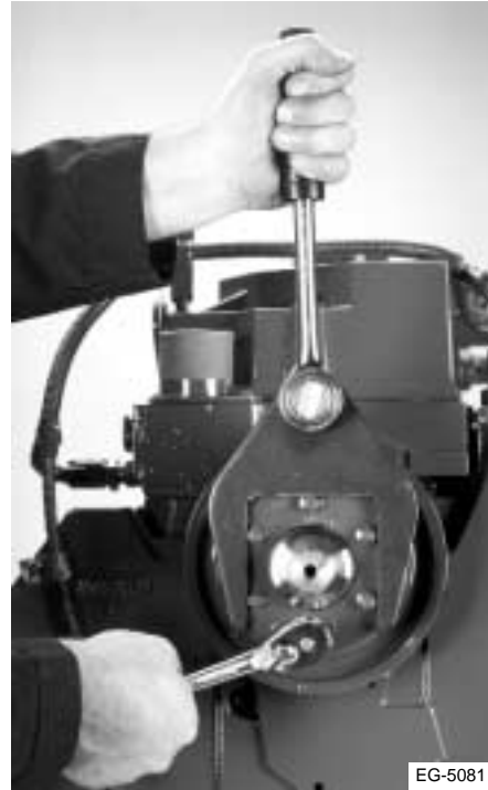
Figura 8.6 Retiro de la polea del núcleo impulsor del ventilador
