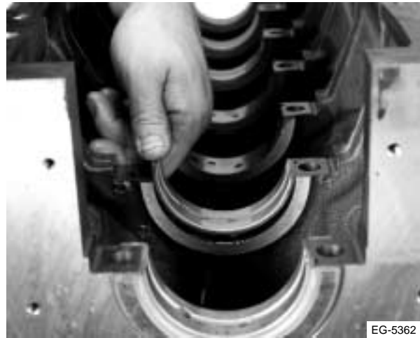
Figura 7.69 Retiro de los casquillos superiores de los cojinetes de bancada
