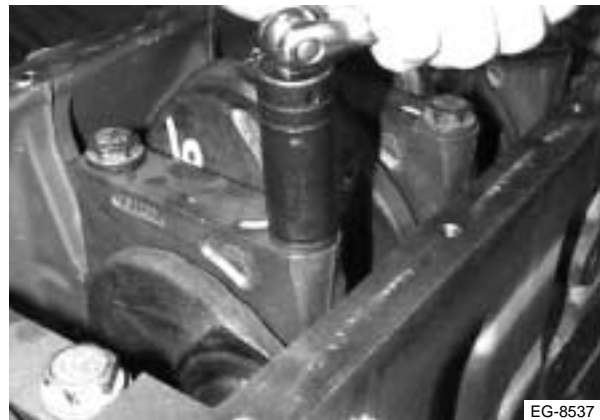
Figura 7.65 Retiro de las tapas de los cojinetes de bancada
