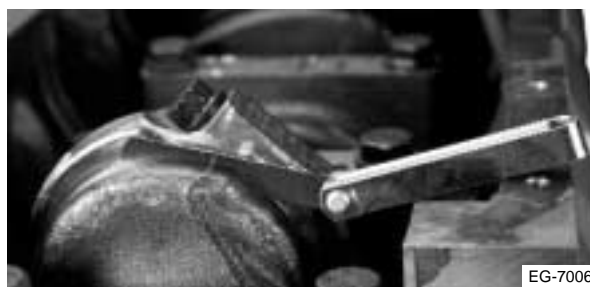
Figura 6.29 Mida el juego entre las bielas y el muñón del cigüeñal
