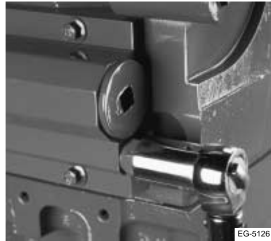
Figura 12.25 Apriete la válvula de retorno de combustible
