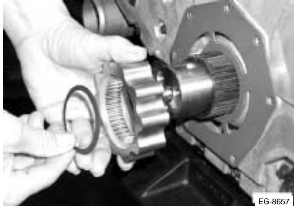
Figura 9.12 Instalación del rotor interior y arandela/sello
