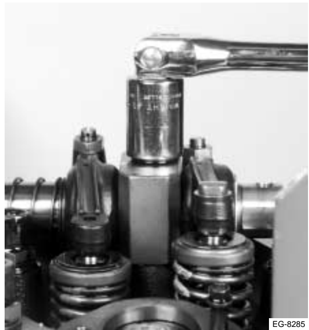
Figura 4.18 Retiro de los pernos de montaje
