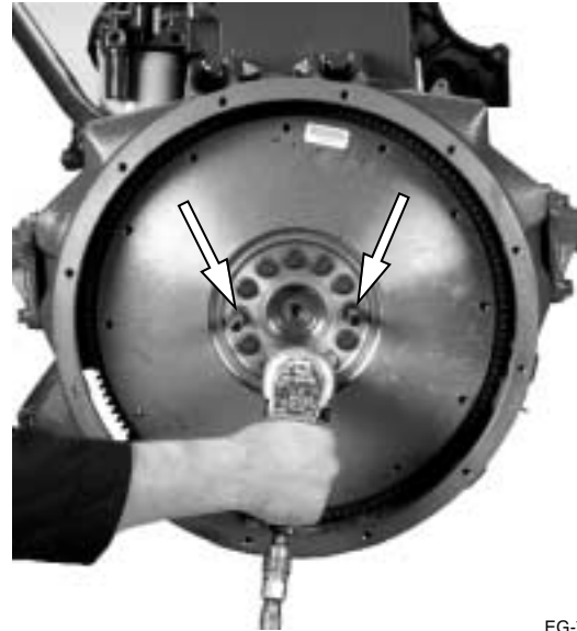
Figura 7.5 Retiro del volante
