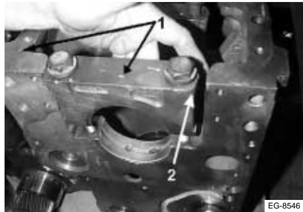
Figura 7.64 Ubicación de las tapas de los cojinetes de bancada
