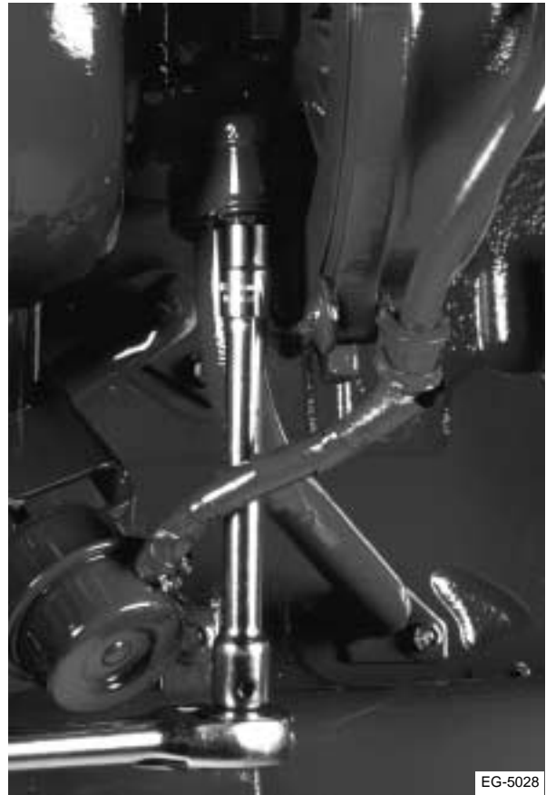
Figura 2.6 Retiro del tubo de drenaje de aceite
