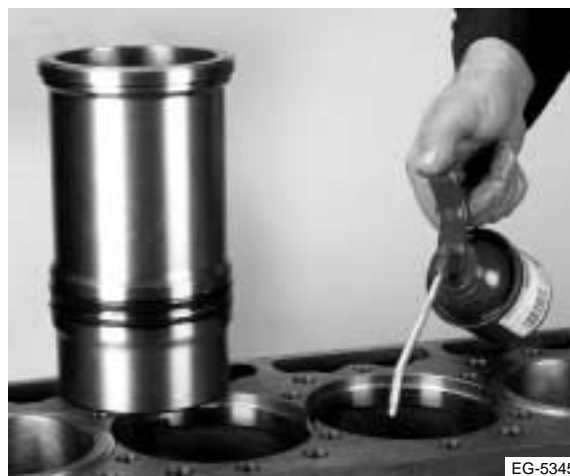
Figura 6.45 Lubrique las cavidades
