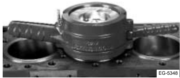
Figura 6.47 Instalación del compresor de anillos
