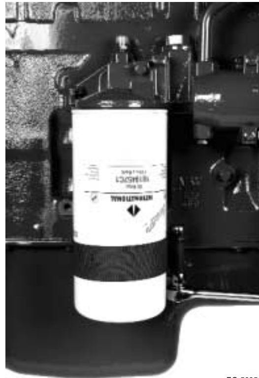
Figura 9.17 Retiro del filtro de aceite
