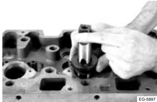
Figura 4.58 Instalación del extractor de camisas
