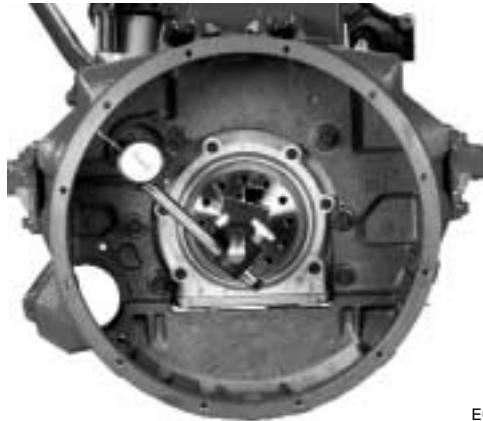
Figura 7.26 Verificación de la concentricidad de la cavidad de la caja protectora del volante
