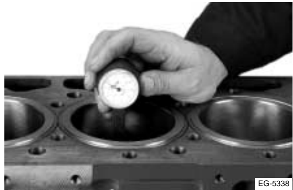
Figura 6.23 Tome la medida debajo del área de recorrido del anillo del pistón con el medidor de diámetros interiores
