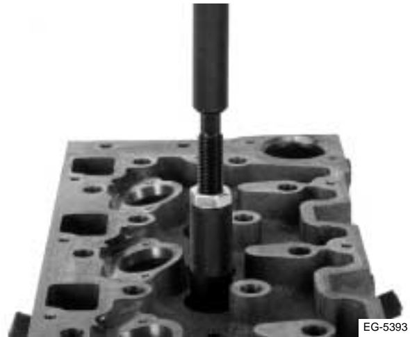
Figura 4.38 Uso del instalador de guías
