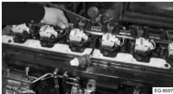
Figura 4.7 Retiro del haz de cables
