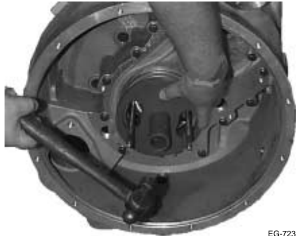
Figura 7.52 Instalación del sello de aceite trasero de la toma de fuerza
