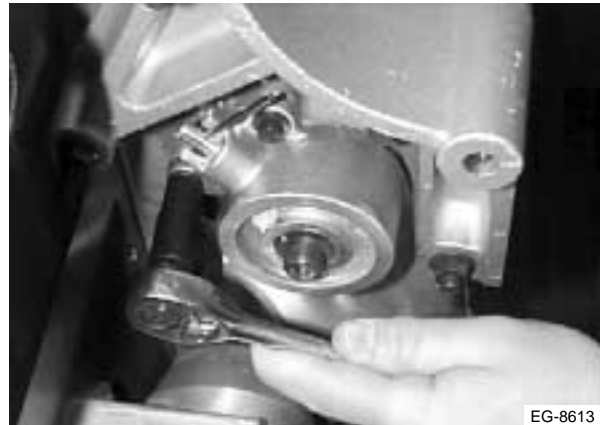
Figura 10.13 Retiro del cabezal del filtro
