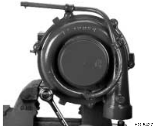
Figura 2.14 Retiro de la caja protectora del compresor
