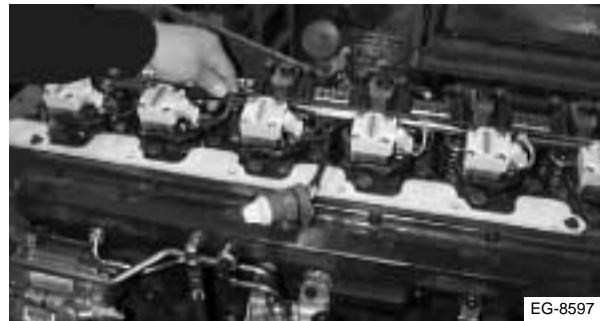
Figura 4.92 Instalación del conducto para cables y deflector de aceite
