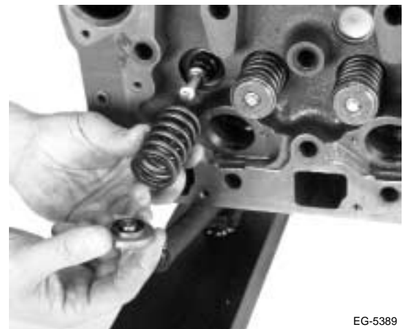
Figura 4.33 Retiro de los componentes de las válvulas
