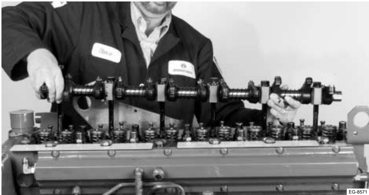
Figura 5.2 Retiro del conjunto de balancines
