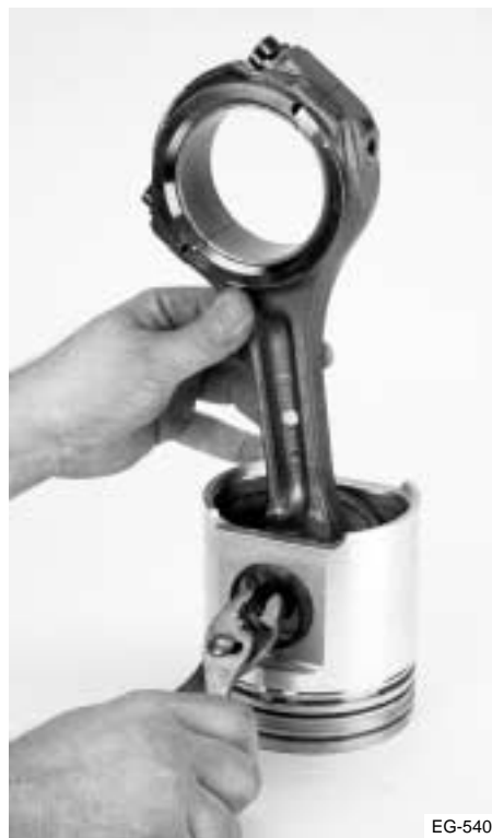
Figura 6.7 Retire los anillos de retención de cada pistón
