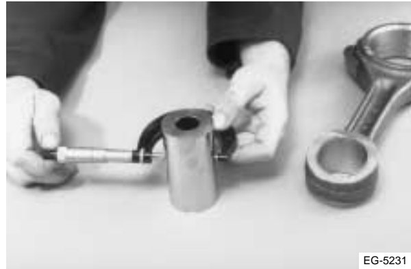
Figura 6.19 Mida el diámetro exterior de los pasadores
