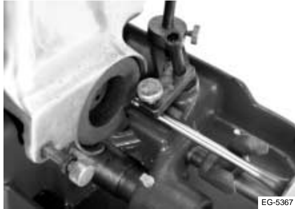
Figura 4.43 Coloque la válvula en el esmerilador
