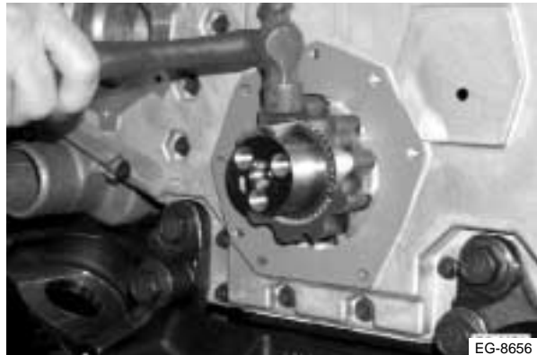
Figura 9.13 Instalación de la chaveta Woodruff
