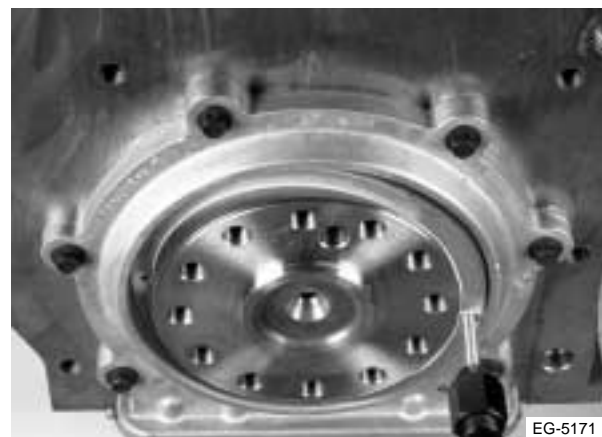
Figura 7.9 Retire del sello de aceite trasero
