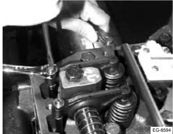
Figura 4.77 Ajuste del juego de las válvulas
