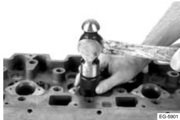
Figura 4.65 Instalación de la camisa
