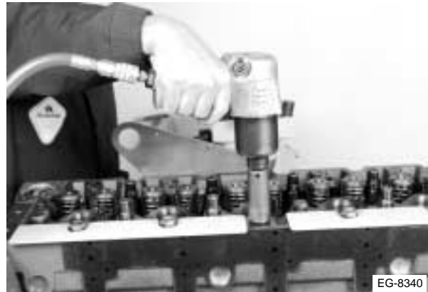
Figura 4.21 Retiro de los pernos de montaje
