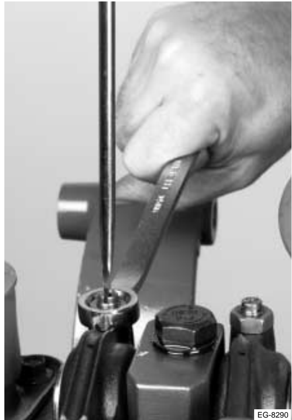
Figura 4.17 Afloje los tornillos de ajuste
