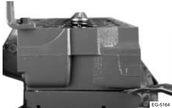
Figura 4.22 Afloje la culata y la empaquetadura del bloque del motor
