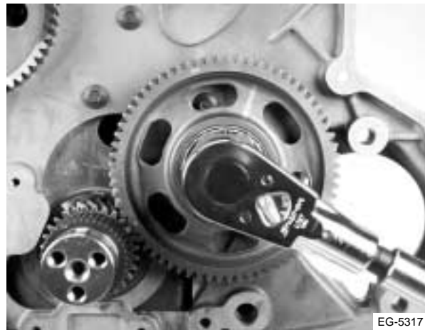
Figura 8.25 Instalación del engranaje libre inferior
