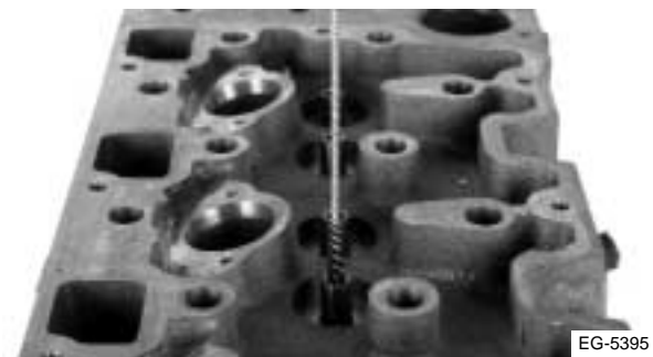
Figura 4.34 Limpieza de las guías
