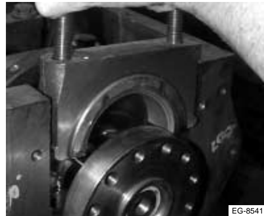
Figura 7.67 Retiro del cojinete trasero de empuje
