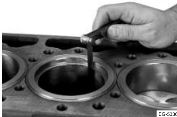
Figura 6.15 Mida la separación de los anillos
