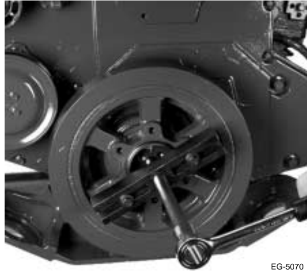
Figura 7.60 Retiro del amortiguador de vibraciones
