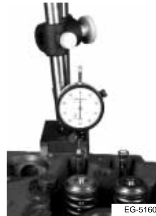
Figura 5.3 Instalación de un indicador tipo reloj con base magnética
