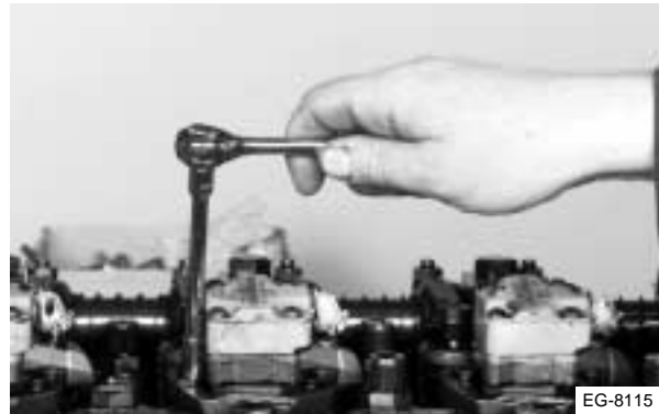
Figura 4.14 Retiro de los pernos de montaje de las abrazaderas de sujeción
