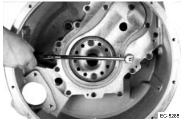
Figura 7.34 Retiro de los tapones roscados
