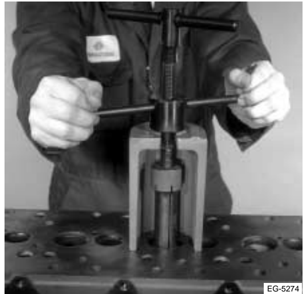
Figura 4.52 Retiro del encastre del asiento
