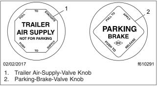
Fig. 15.2, Brake Valve Knobs
