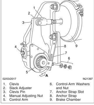
Fig. 25.2, Haldex Automatic Slack Adjuster
