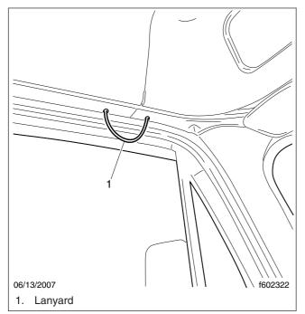
Fig. 4.10, Air Horn Control
