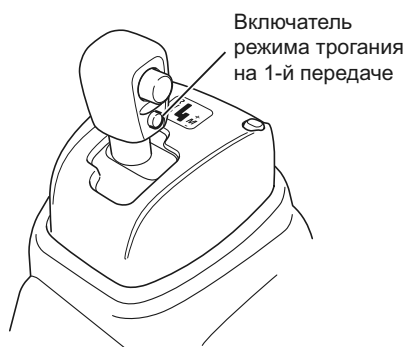
Индикатор режима начала движения на 1-й передаче
