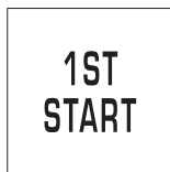
Индикатор режима начала движения на 1-й передаче
