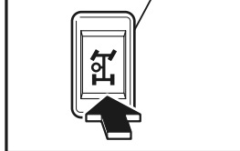
Индикатор механизма отбора мощности (PTO)
