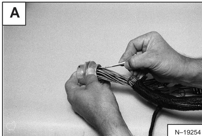
Cuando realice diagnósticos, si encuentra que un pin conector Metri-pac está empujado hacia atrás dentro de un conector, retire dicho pin y doble nuevamente la lengüeta liberadora pequeña.
