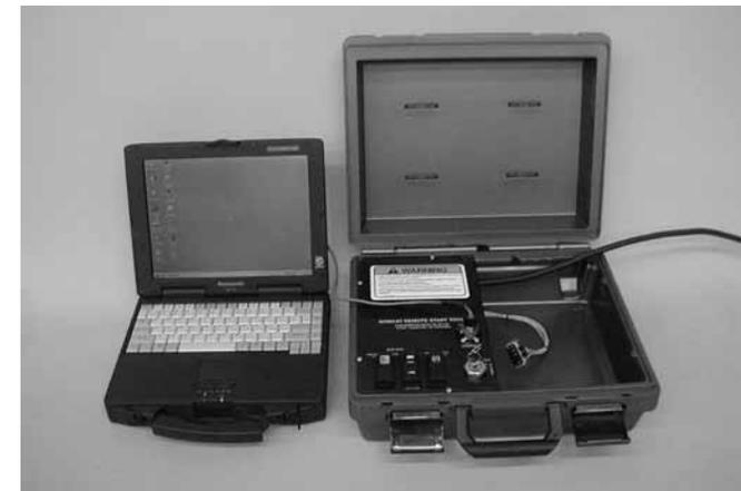
Voltee la llave a “Run” en la herramienta para arranques remotos.
