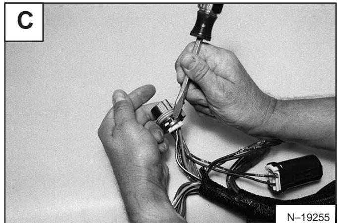
Deslice el lado posterior fuera del conector [D].
