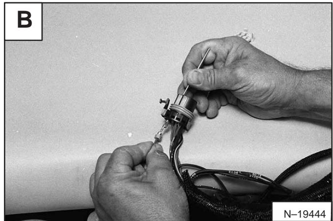
Es difícil realizar el mantenimiento de los cuatro conectores Metri-Pac que se enchufan dentro del controlador Bobcat [C].
