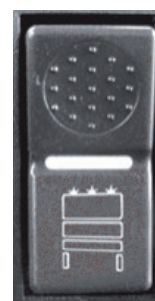
Переключатель потолочного плафона
