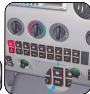
открыть крышку блока переключателей (на стороне водителя)
