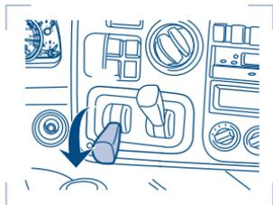
Se necessário, acione o freio do semireboque antes de aplicar o freio de serviço (freio de pedal), a fim de evitar o efeito “L” do semireboque sobre o cavalo mecânico.
