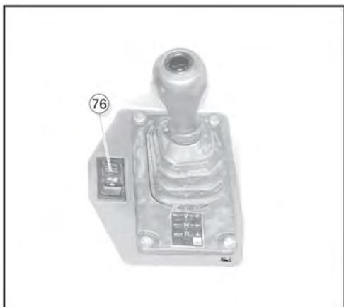
**76. Блокировка дифференциала промежуточного моста 77\***
