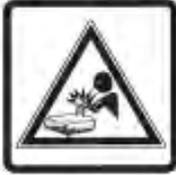
**Осторожно – Возможен выход горячей охлаждающей жидкости**
