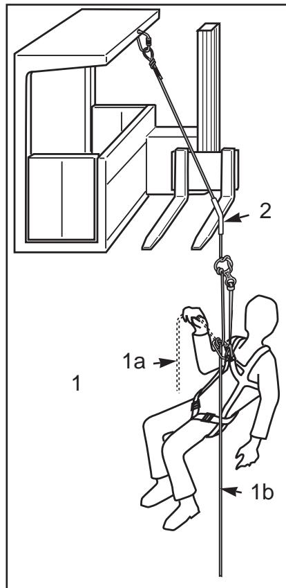
Zum Abseilen ist lediglich das Seil in Richtung Karabinerhaken zu führen (1a). Dadurch wird die Bremswirkung reduziert und das Seil beginnt durchzurutschen. Zurückführen des Seiles in die Senkrechte oder einfaches Hängenlassen des Seils (z.B. bei Bewußtlosigkeit des Bedieners, 1b) stoppt den Abseilvorgang.
