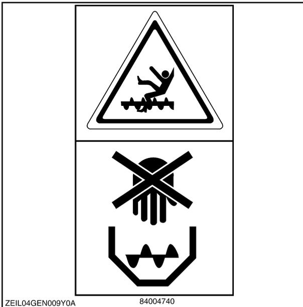
Запрещается выполнять какие-либо действия или входить в зерновой бункер при работающем двигателе.
