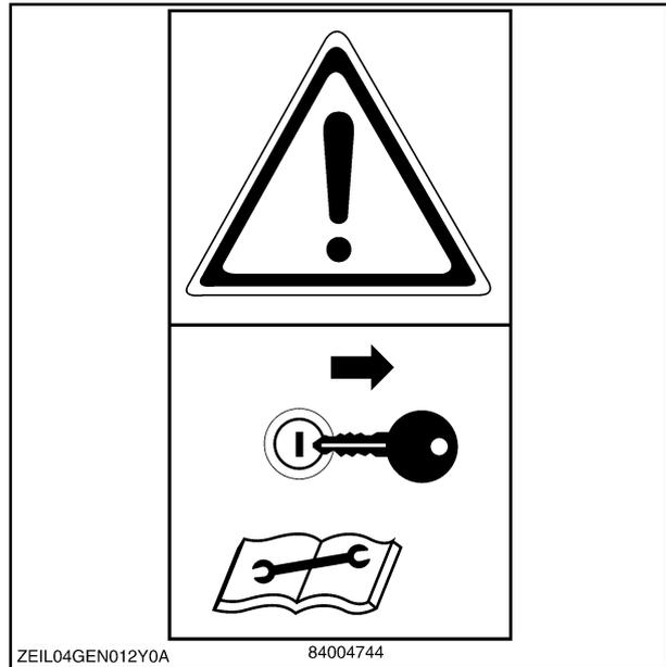
Прежде чем приступить к техобслуживанию или ремонту, выключить двигатель и вынуть ключ из замка зажигания.
