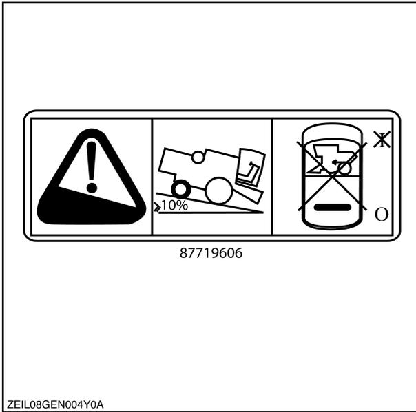
Отключить систему Power Rear Axle, прежде чем начать спуск, включить скорость, соответствующую наклону местности
