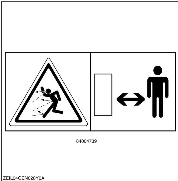
ОПАСНОСТЬ: Держитесь на безопасном расстоянии от работающего двигателя.
