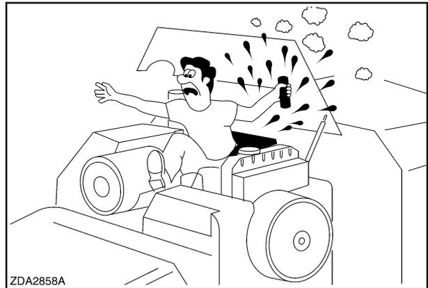
Нарушение этой инструкции может привести к серьёзным травмам вследствие контакта с горячим охладителем и/или стать причиной повреждения системы охлаждения или двигателя.
