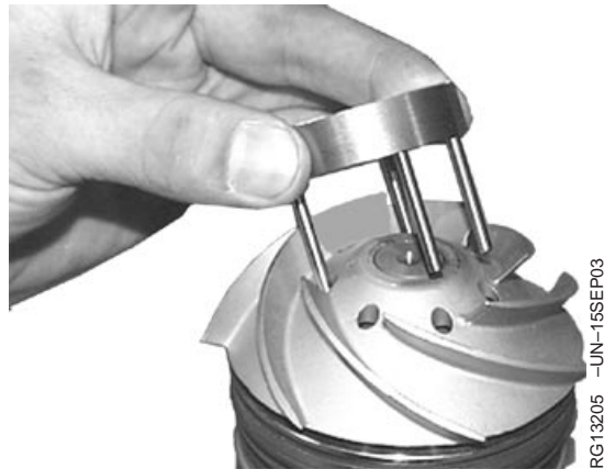
Herramienta de servicio de bomba de refrigerante
