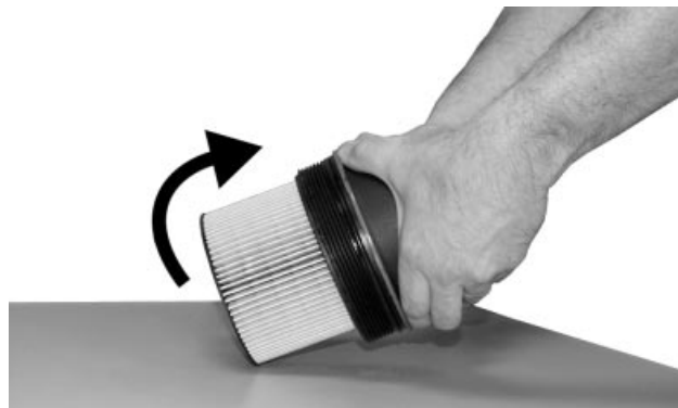
Golpear contra una superficie para retirar el filtro
