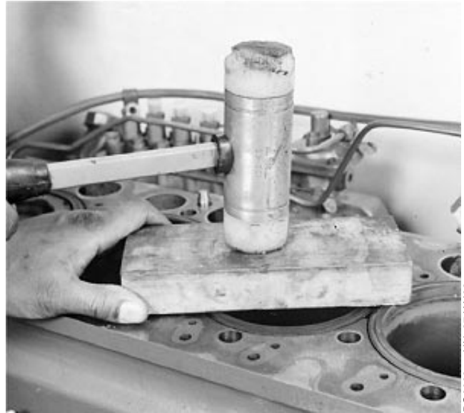
Asentamiento de camisas de cilindros en bloque
