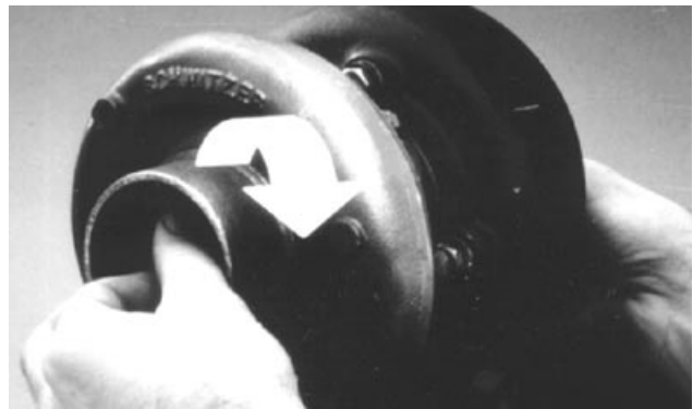
Comprobación de rotación y espacio libre del eje
