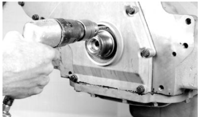
Taladrado de agujero en pieza fundida de sello de aceite delantero
