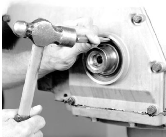
Uso de punzón en pieza fundida del sello de aceite
