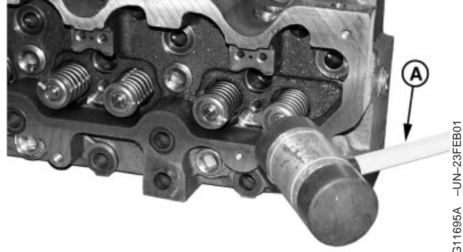
Asentamiento de retenedores en válvulas
