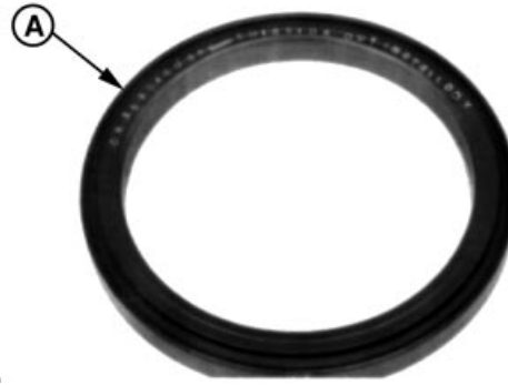
Sello de aceite trasero y manguito de desgaste
