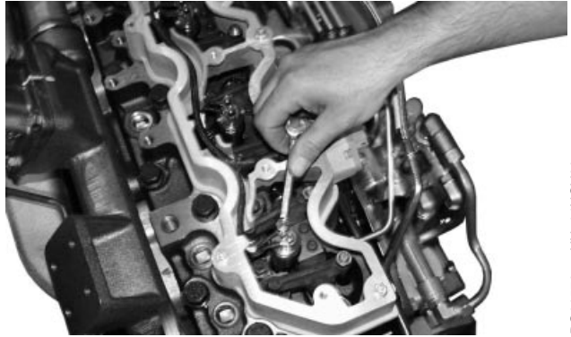
Instalación de tuercas retenedoras de alambres del solenoide en espárragos de inyectores
