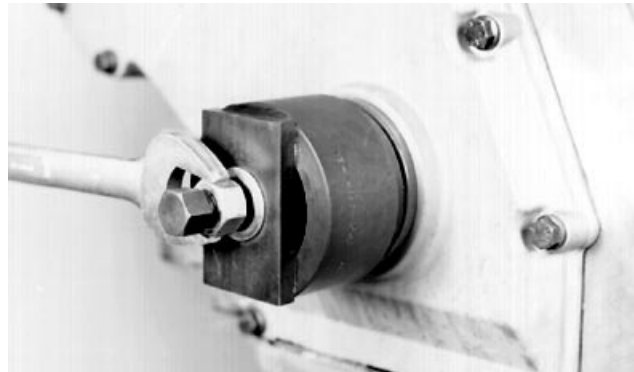
Instalación del sello de aceite delantero
