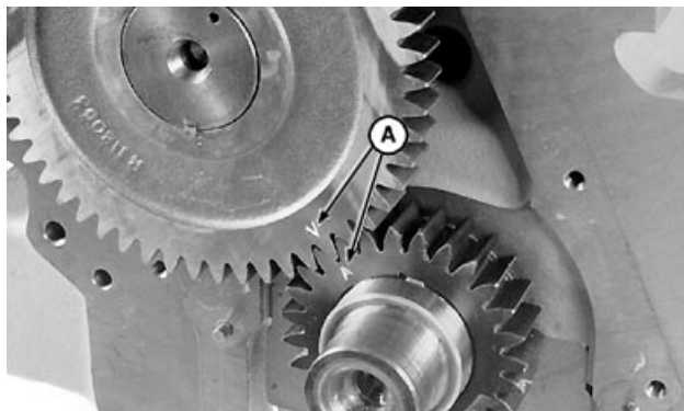
Marcas de sincronización—Engranajes de árbol de levas y cigüeñal
