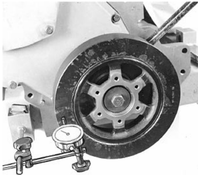
Revisión del juego axial del cigüeñal
