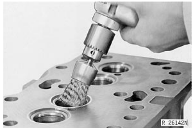
Limpieza de asientos de válvulas
