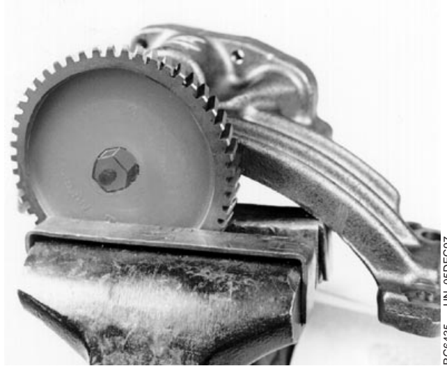
Inspección de engranaje impulsor de bomba de aceite
