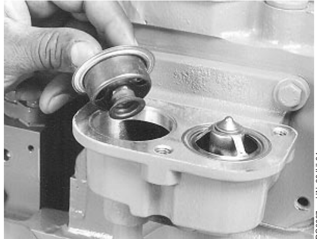
Retiro de termostatos
