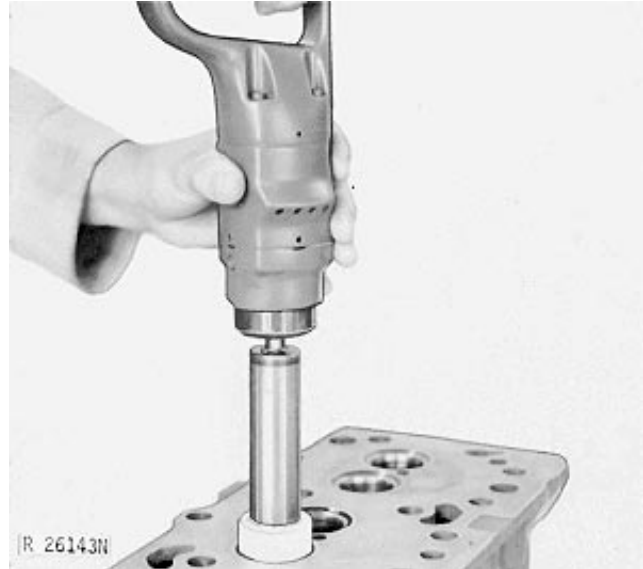
Rectificación de los asientos de las válvulas
