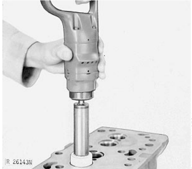
Rectificación de los asientos de las válvulas
