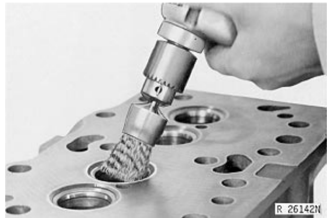
Limpieza de asientos de válvulas
