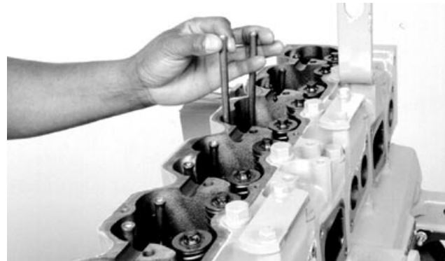
Retiro de varillas de empuje
