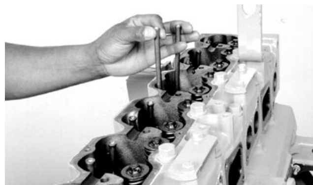
Instalación de varillas de empuje y tapas
