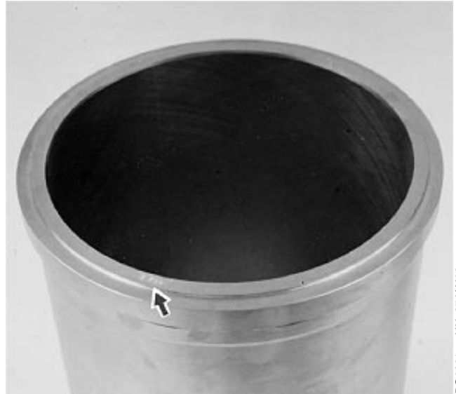
Código de cuatro dígitos en camisa de cilindro
