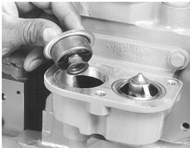
Instalación de termostatos
