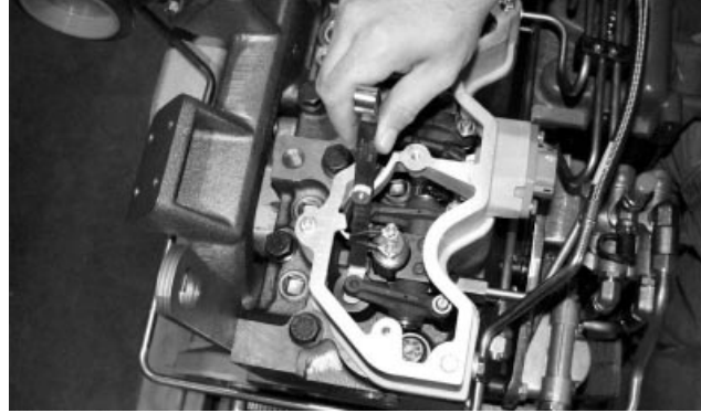
Revisión del juego de las válvulas usando un calibrador de espesores doblado
