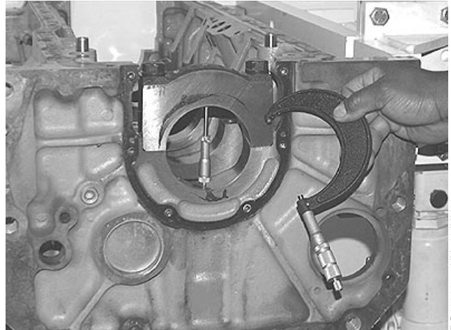
Medición de cavidades de tapas de cojinetes de bancada
