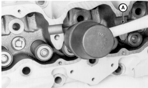
Asentamiento de retenedores en válvulas
