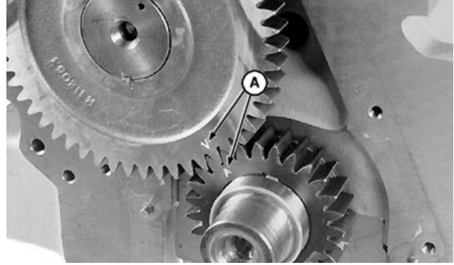
Marcas de sincronización—Engranajes de árbol de levas y cigüeñal
