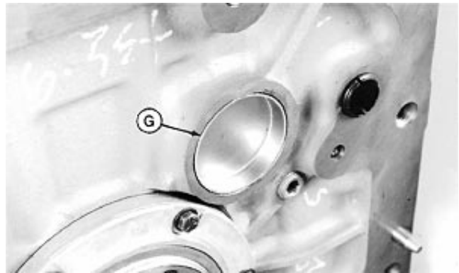
Tapón de cavidad trasera del árbol de levas
