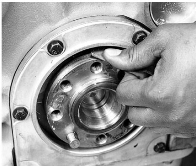
Limpieza de brida del cigüeñal
