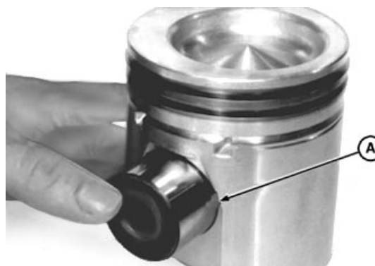
Instalación del pasador en el pistón
